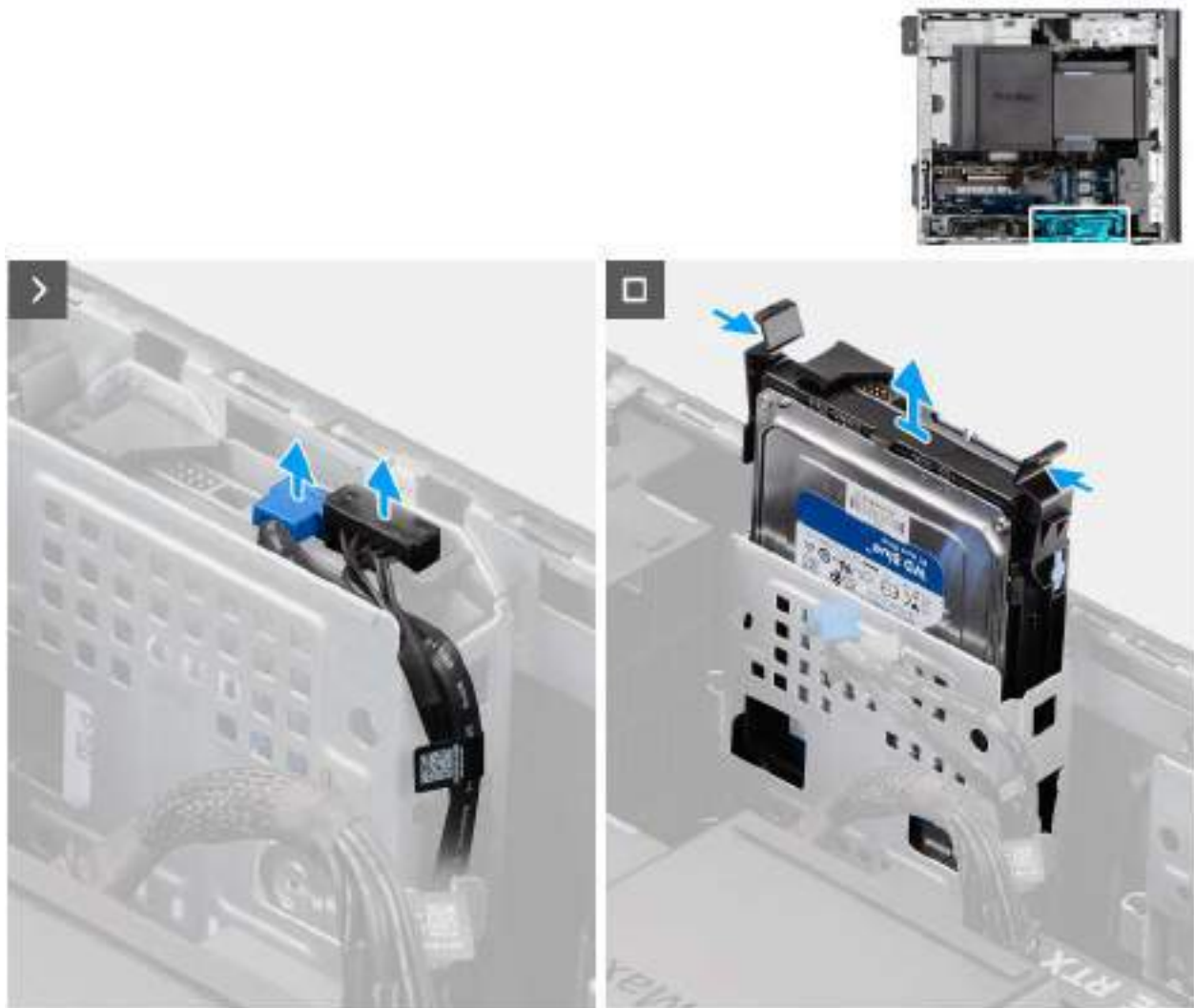
Figure 28. Retrait de l'assemblage de disque dur de 3,5 pouces de la baie 1
