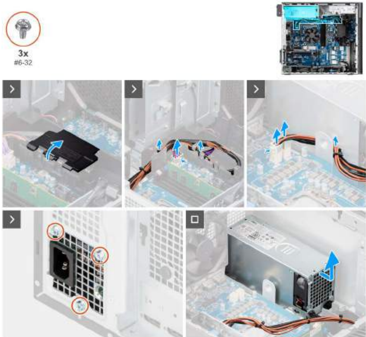
Figure 74. Retrait du bloc d'alimentation de 360 W
