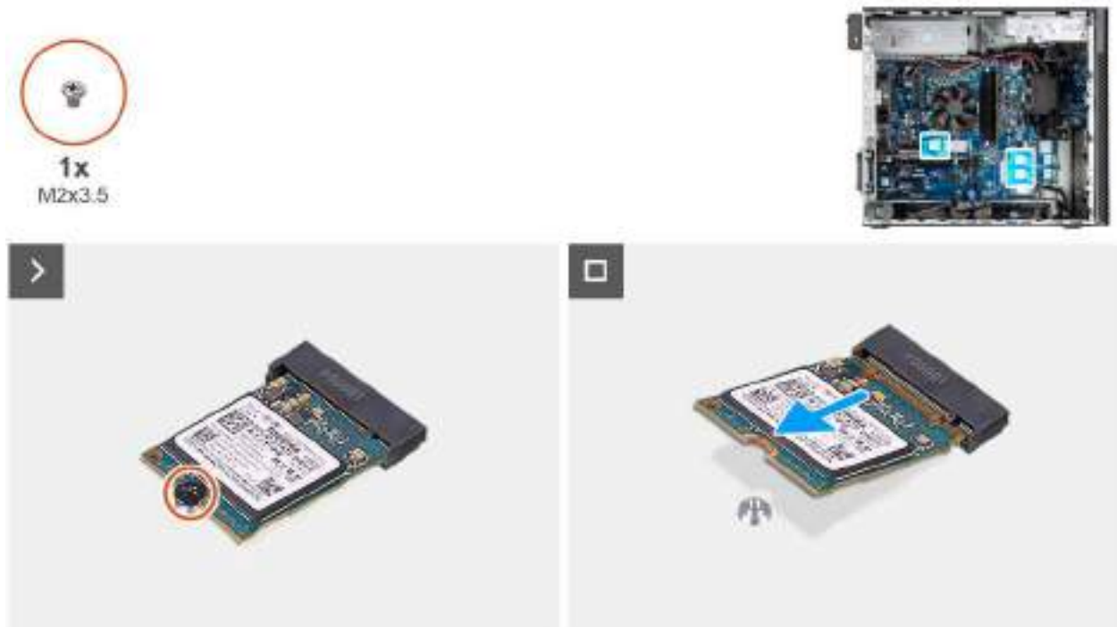
Figure 34. Retrait du disque SSD M.2 2230 PCIe
