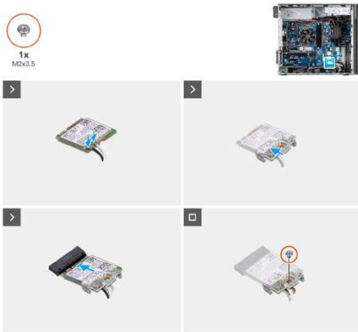
Figure 59. Installation de la carte sans fil
