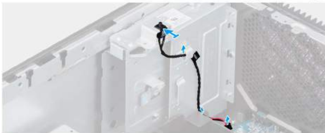
Figure 61. Installation du commutateur d'intrusion
