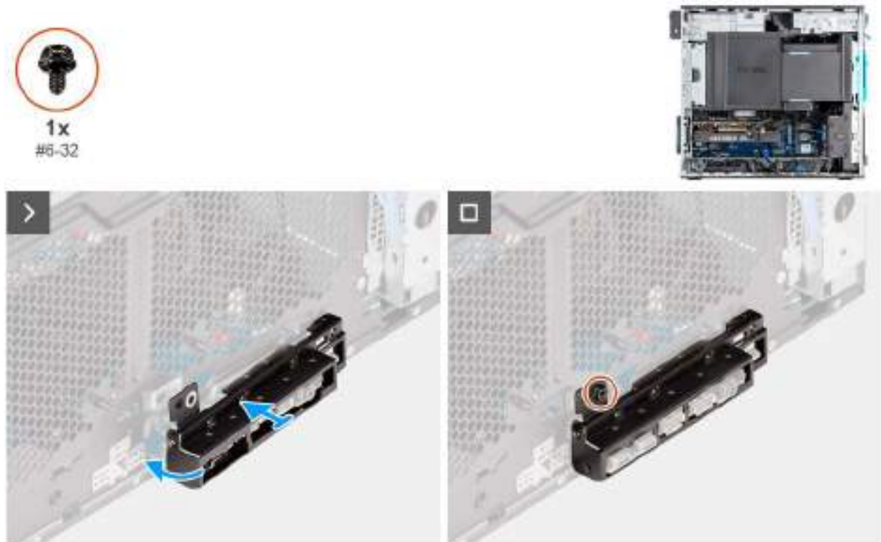
Figure 21. Installation du support d'E/S avant
