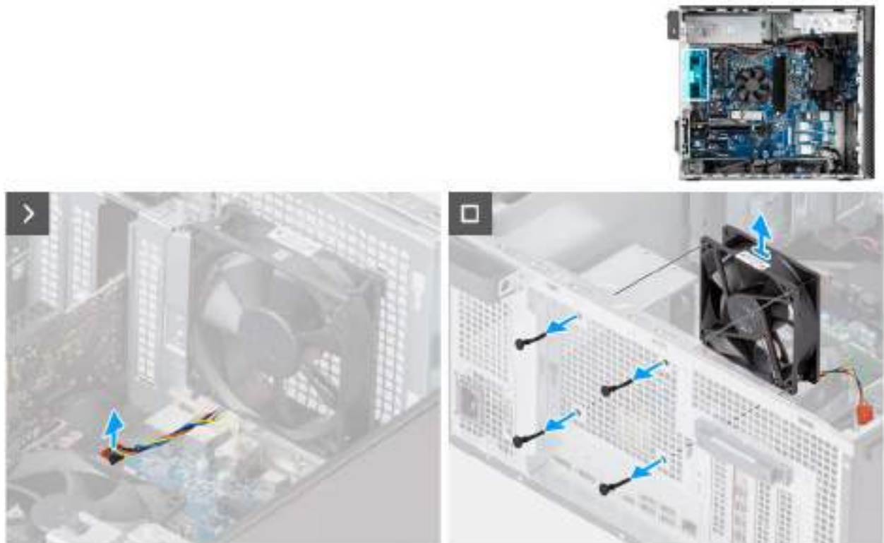
Figure 66. Retrait du ventilateur arrière pour les ordinateurs à bloc d'alimentation de 360 W
