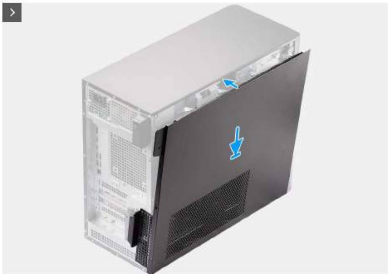
Figure 12. Installation du panneau latéral
