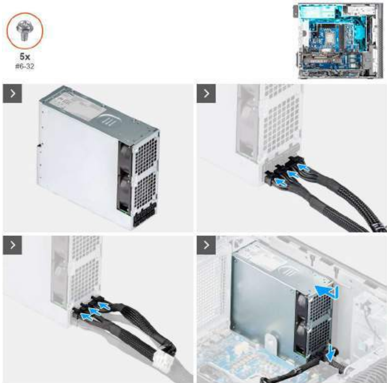
Figure 72. Installation du bloc d'alimentation de 1500 W
