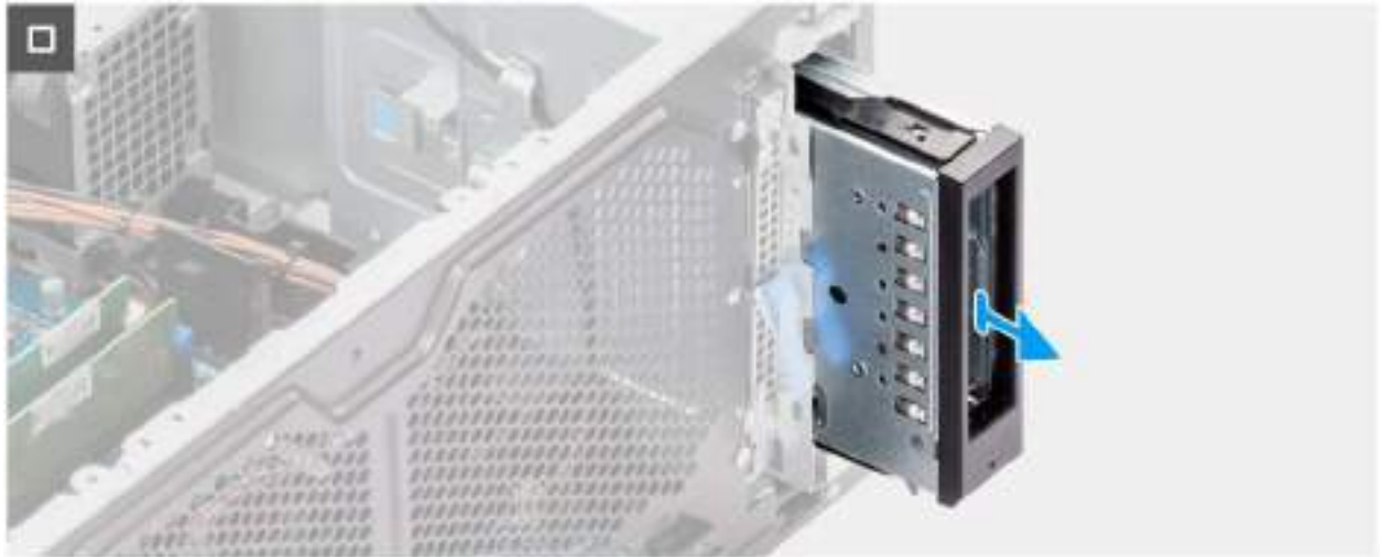
Figure 42. Retrait du module NVMe avant
