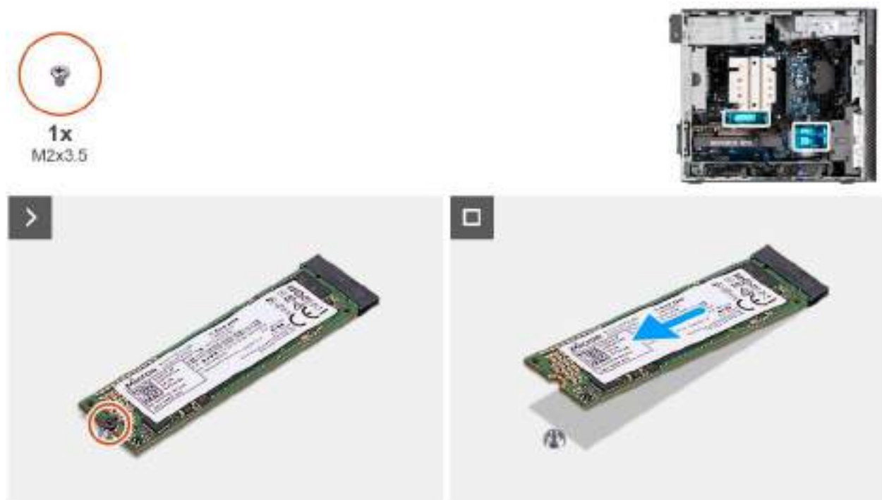
Figure 36. Retrait du disque SSD M.2 2280 PCIe
