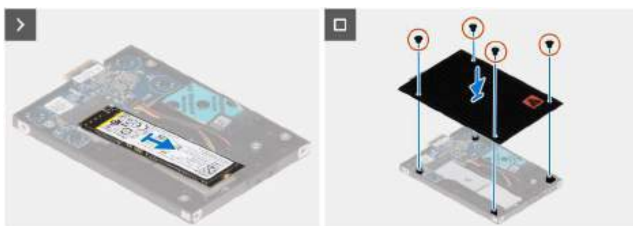
Figure 44. Retrait du disque SSD M.2 du support
