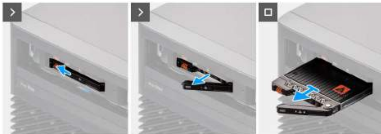
Figure 39. Retrait du support de disque SSD M.2
