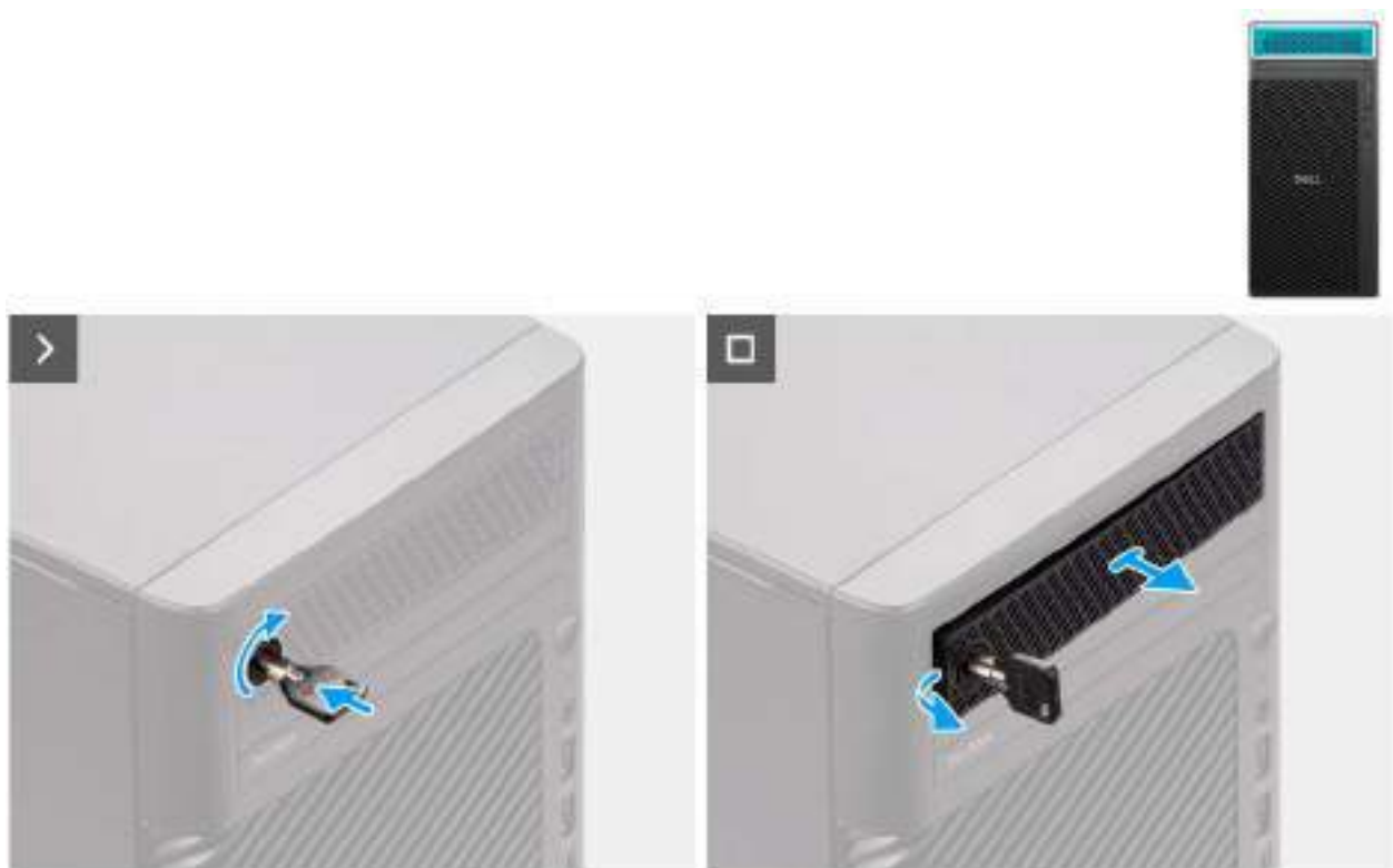
Figure 38. Retrait du cache NVMe avant
