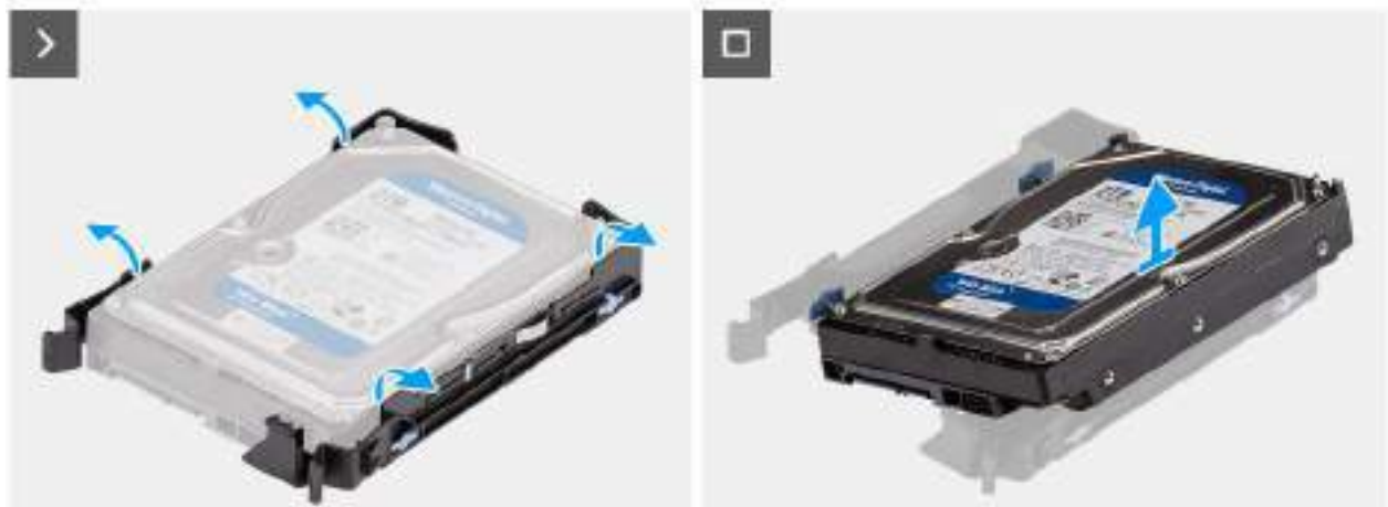
Figure 30. Retrait du support de disque dur de 3,5 pouces
