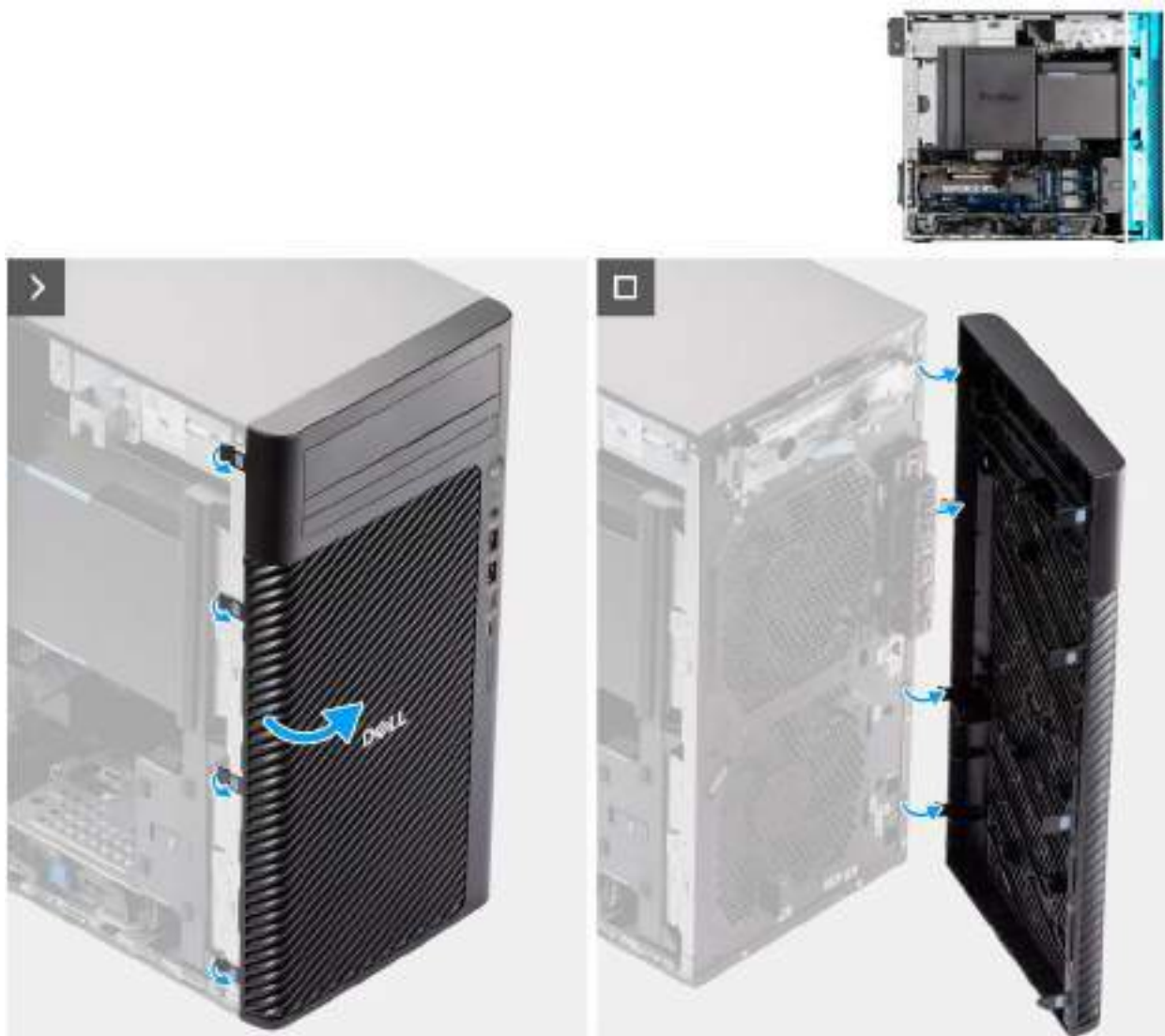
Figure 18. Retrait du panneau avant
