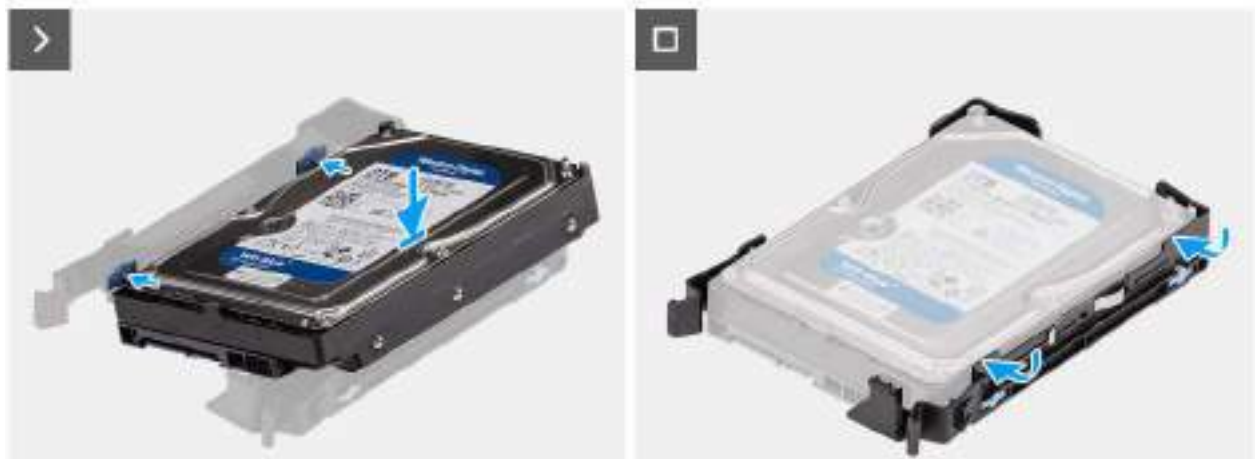
Figure 31. Installation du support de disque dur de 3,5 pouces
