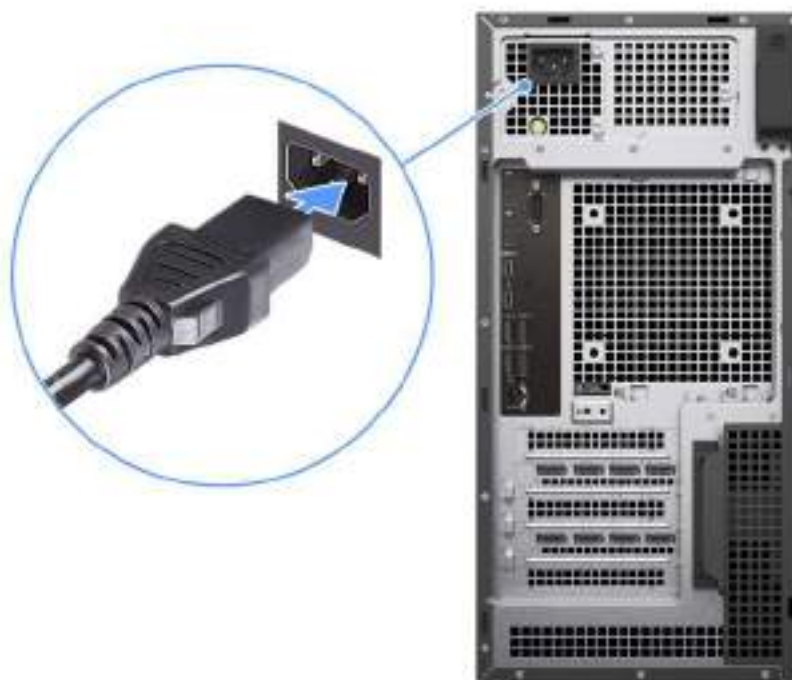
Figure 7. Branchement du câble d'alimentation
