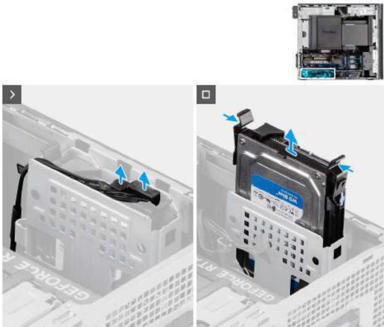
Figure 29. Retrait de l'assemblage de disque dur de 3,5 pouces (baie 2)
