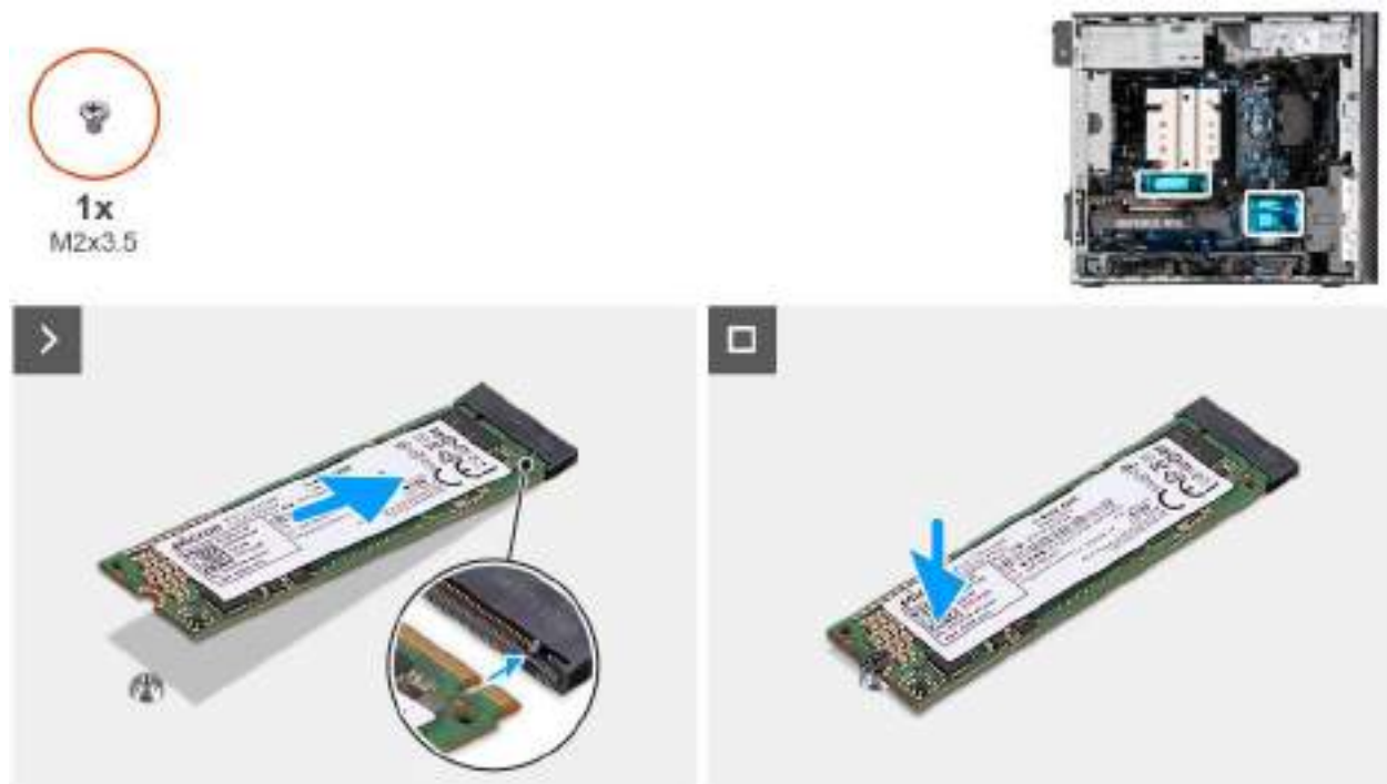
Figure 37. Installation du disque SSD M.2 2280 PCIe
