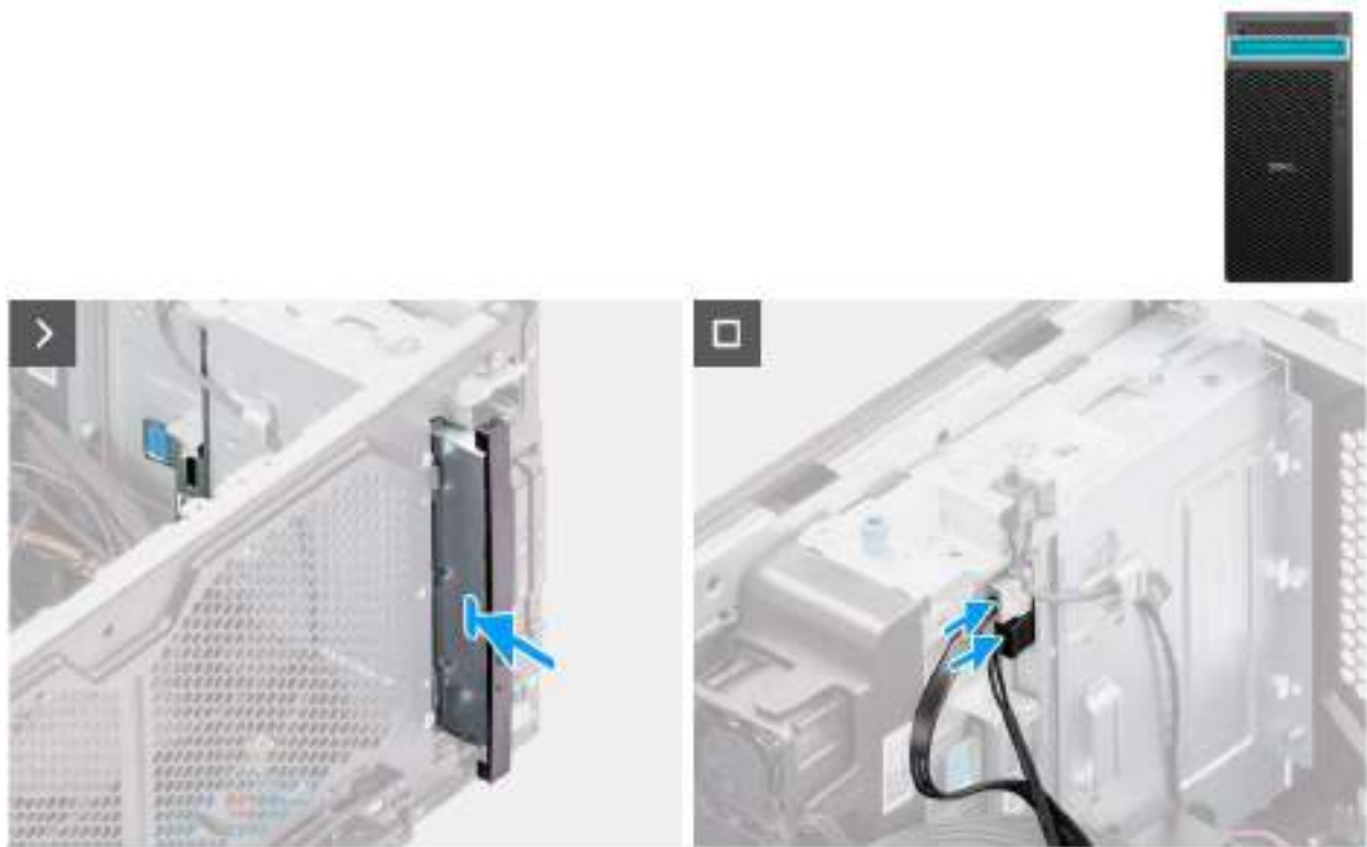
Figure 23. Installation du lecteur optique
