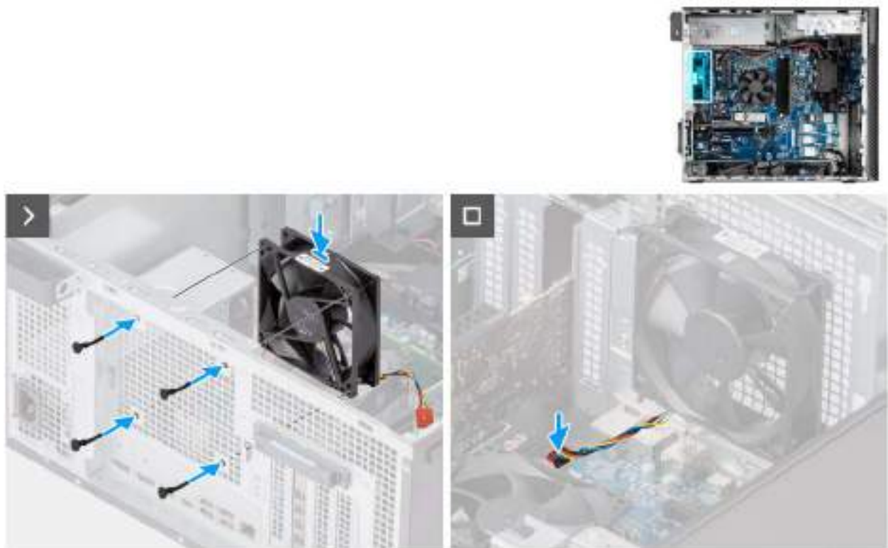
Figure 67. Installation du ventilateur arrière pour les ordinateurs à bloc d'alimentation de 360 W
