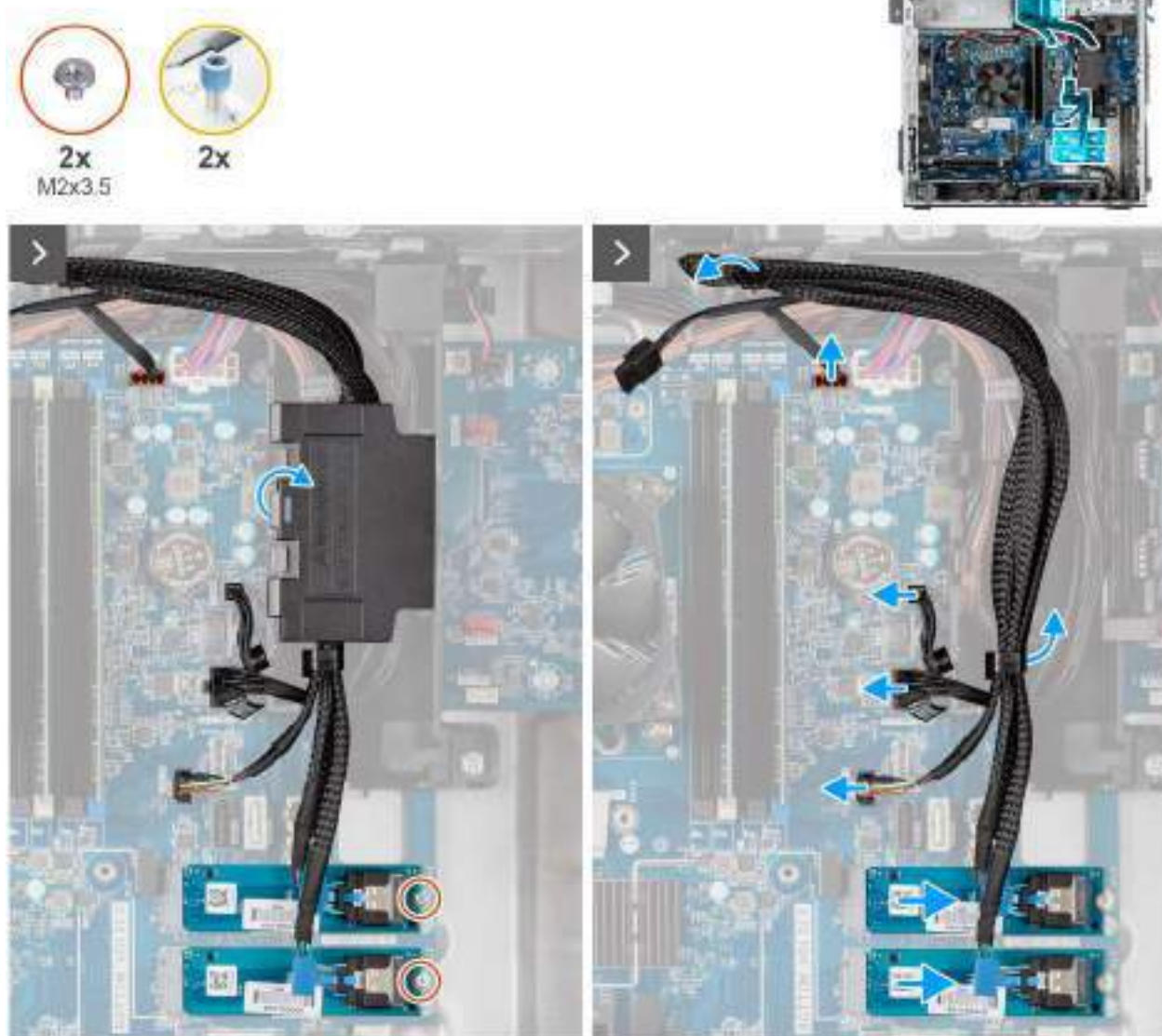
Figure 40. Retrait des câbles du module NVMe avant
