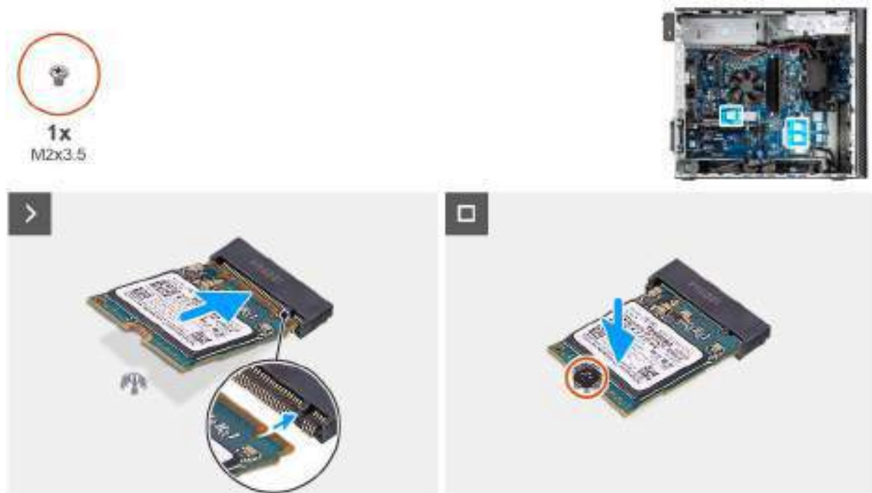
Figure 35. Installation du disque SSD M.2 2230 PCIe
