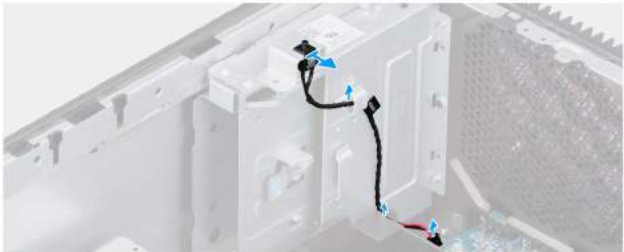
Figure 60. Retrait du commutateur d'intrusion
