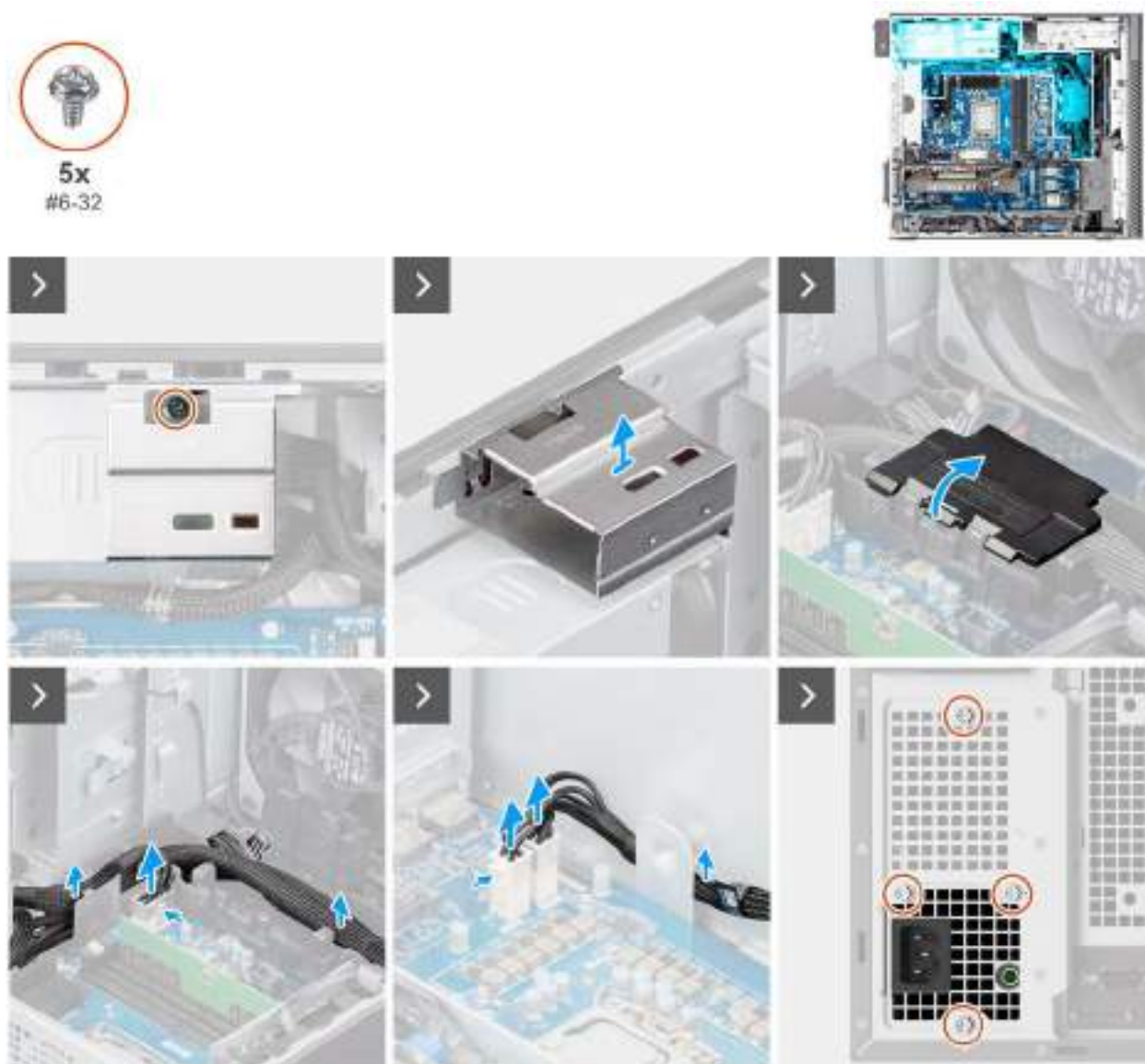
Figure 70. Retrait du bloc d'alimentation de 1500 W
