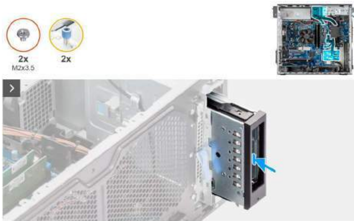
Figure 47. Installation du module NVMe avant
