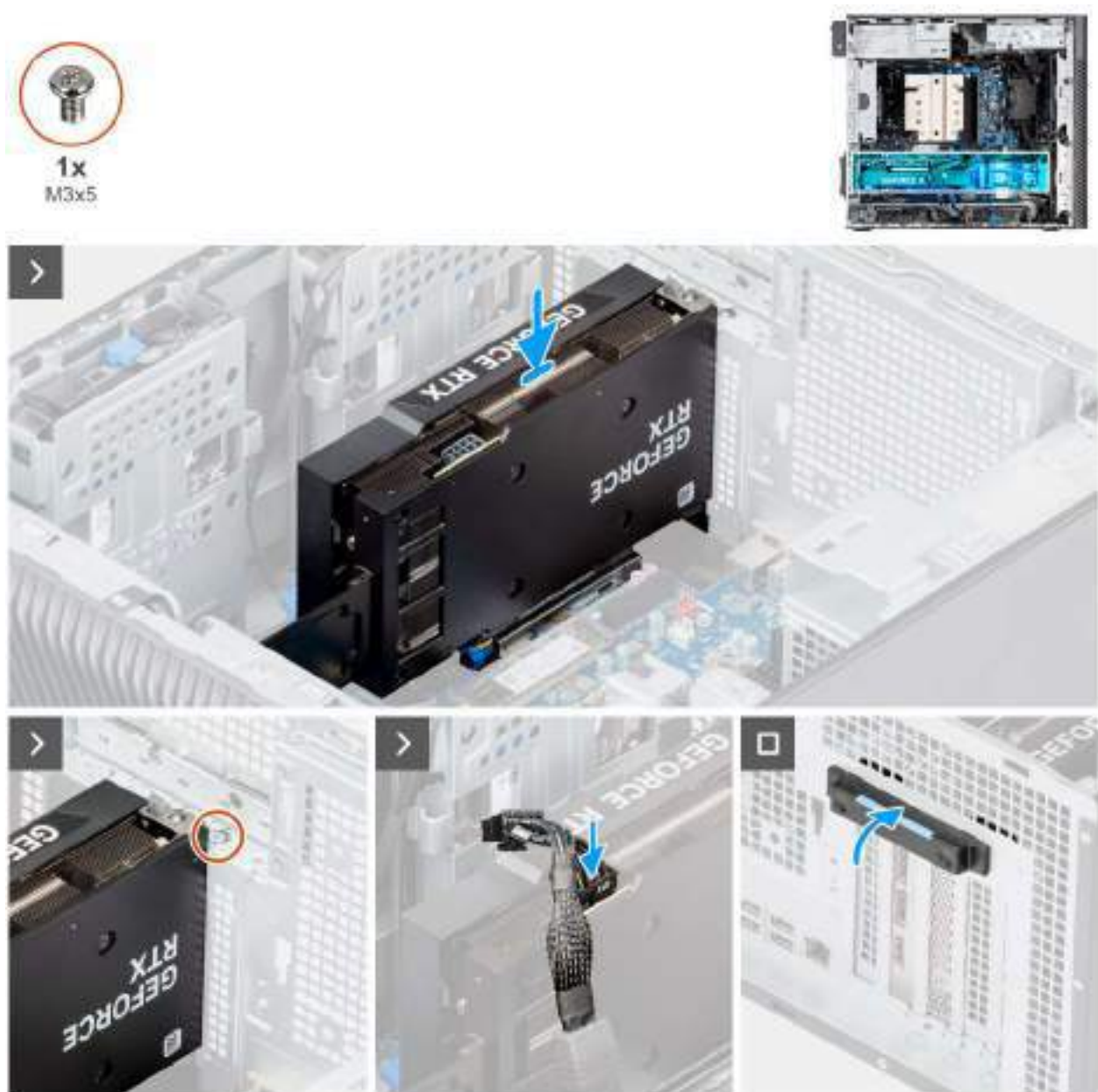
Figure 57. Installation de la carte graphique alimentée
