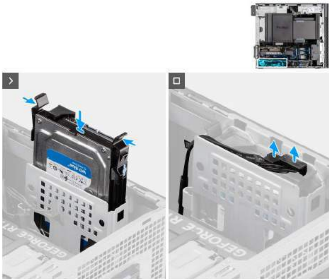
Figure 32. Installation de l'assemblage de disque dur de 3,5 pouces (baie 2)
