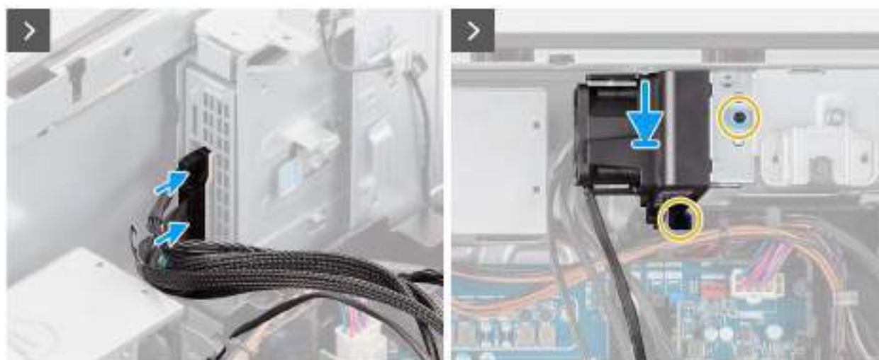
Figure 48. Installation du module de ventilateur NVMe avant
