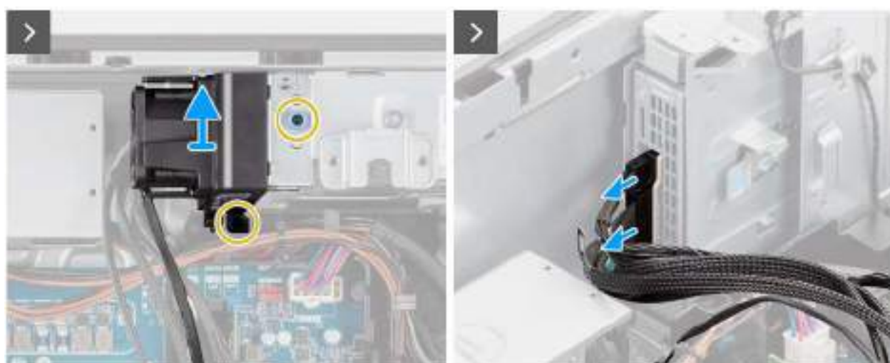
Figure 41. Retrait du module de ventilation NVMe avant
