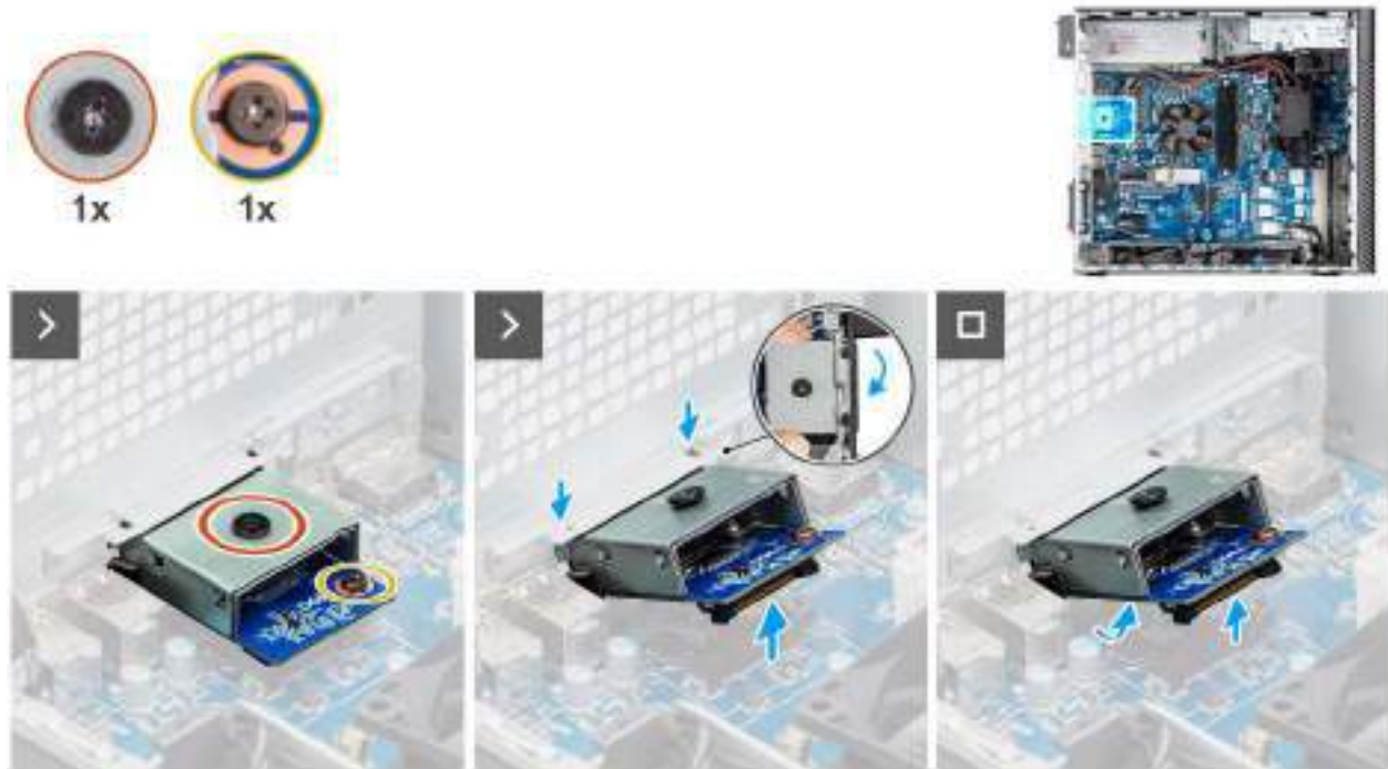
Figure 87. Retrait du module HDMI en option
