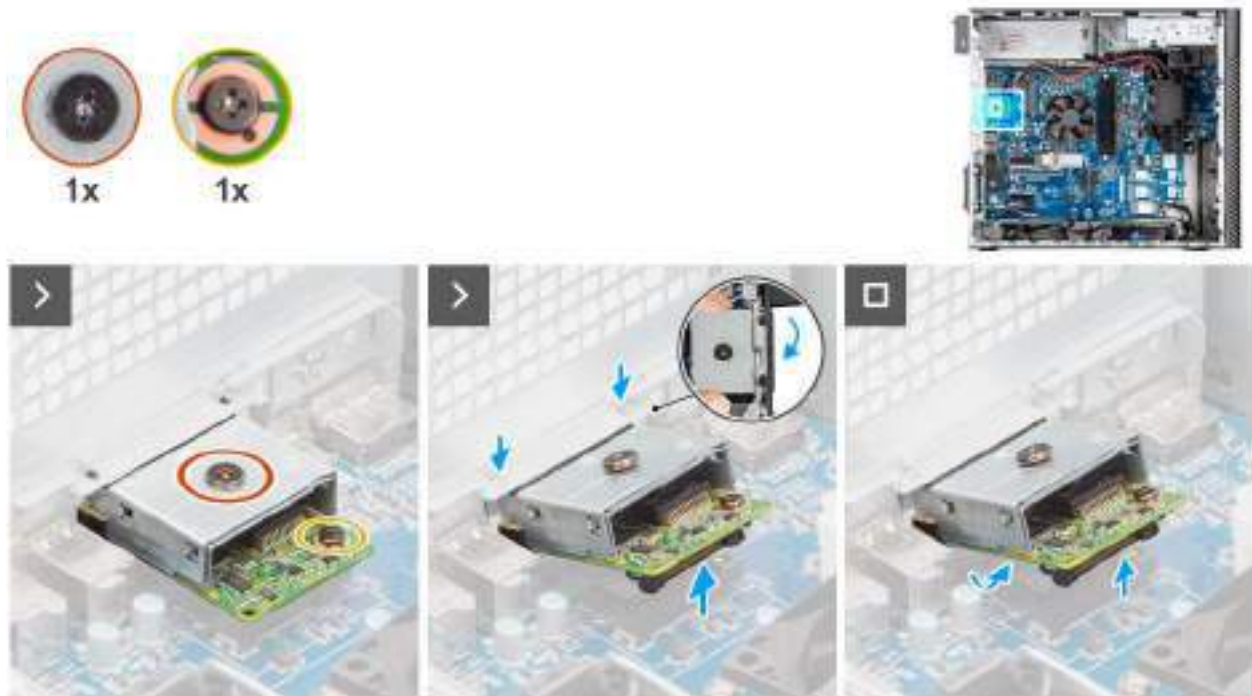
Figure 93. Retrait du module LAN en option
