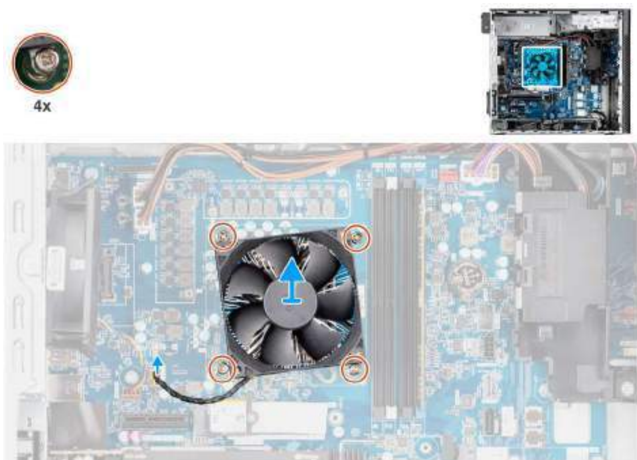
Figure 78. Retrait de l'assemblage du ventilateur et du dissipateur de chaleur 65 W du processeur
