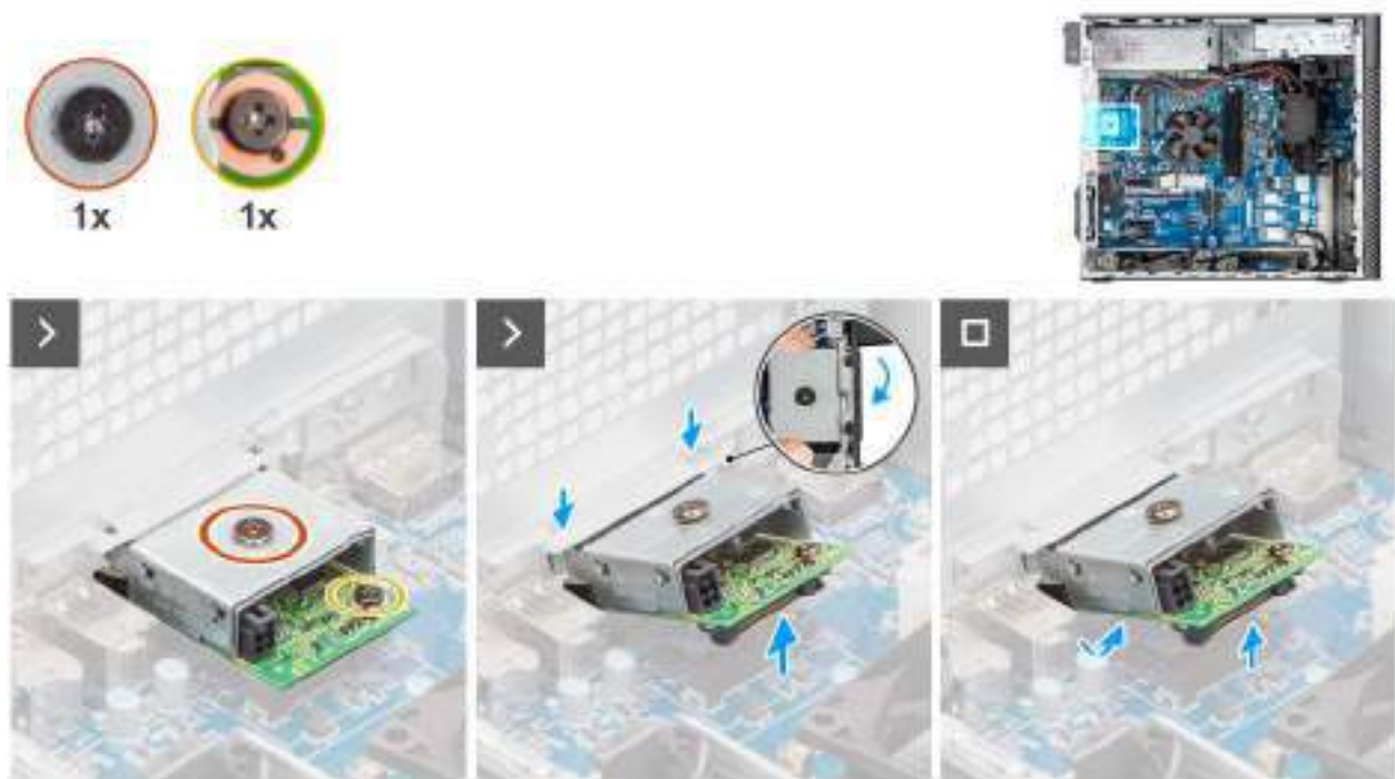
Figure 99. Retrait du module USB en option
