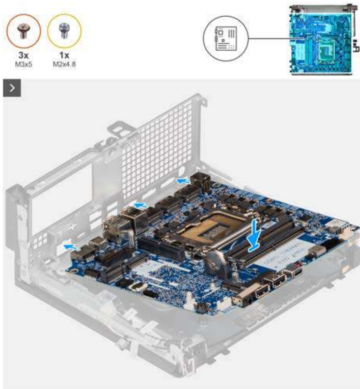
Figure 55. Installation de la carte système
