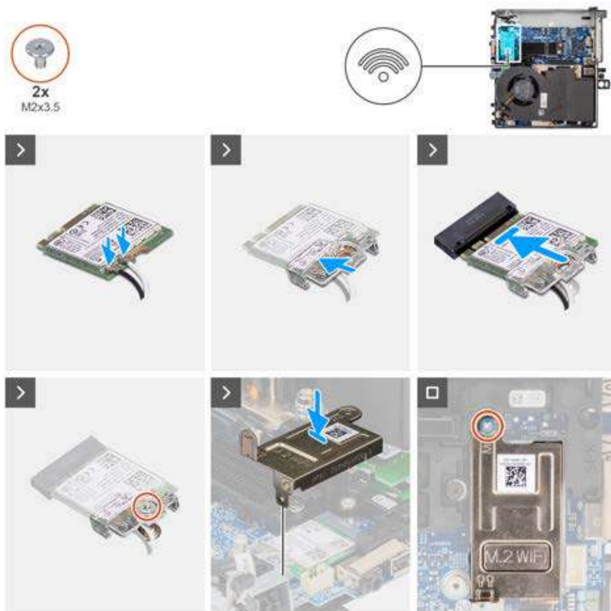
Figure 27. Installation de la carte sans fil
