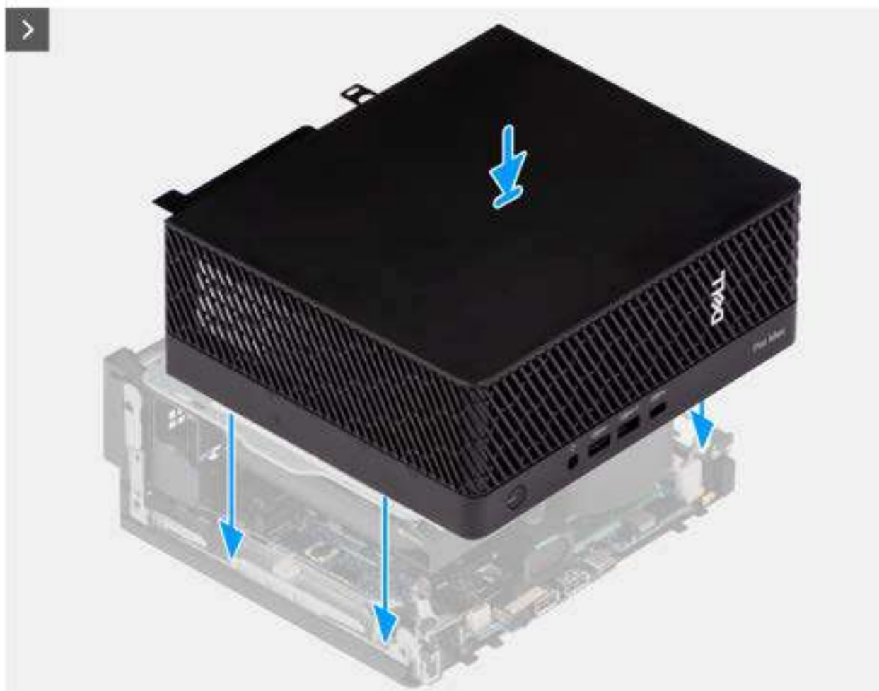
Figure 6. Installation du panneau latéral
