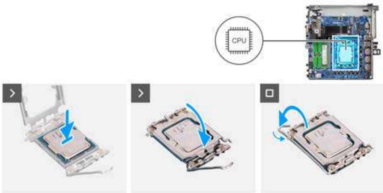
Figure 50. Installation du processeur
