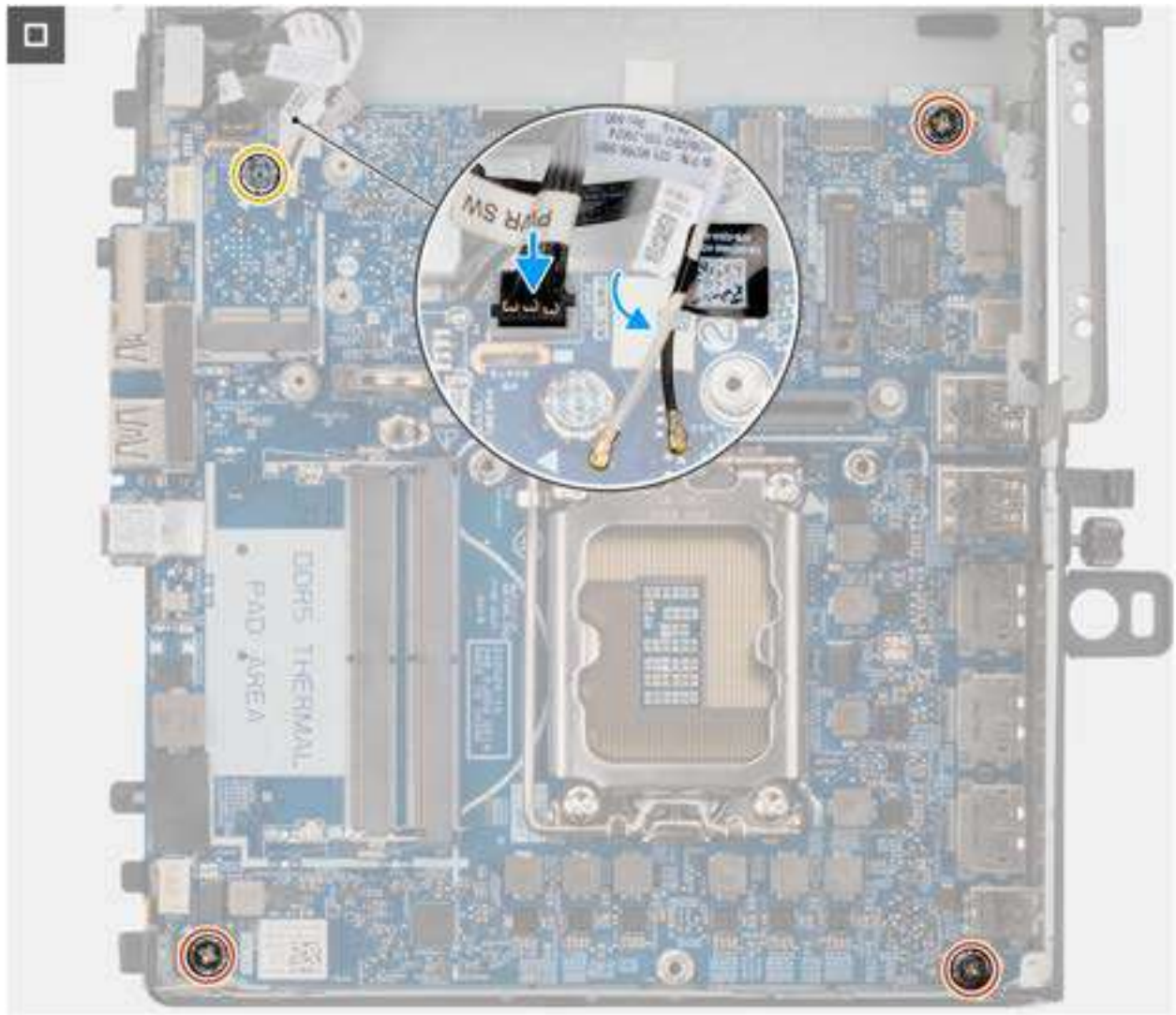
Figure 56. Installation de la carte système
