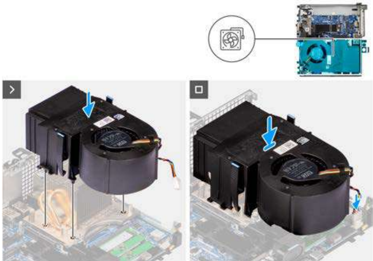
Figure 17. Installation du ventilateur système
