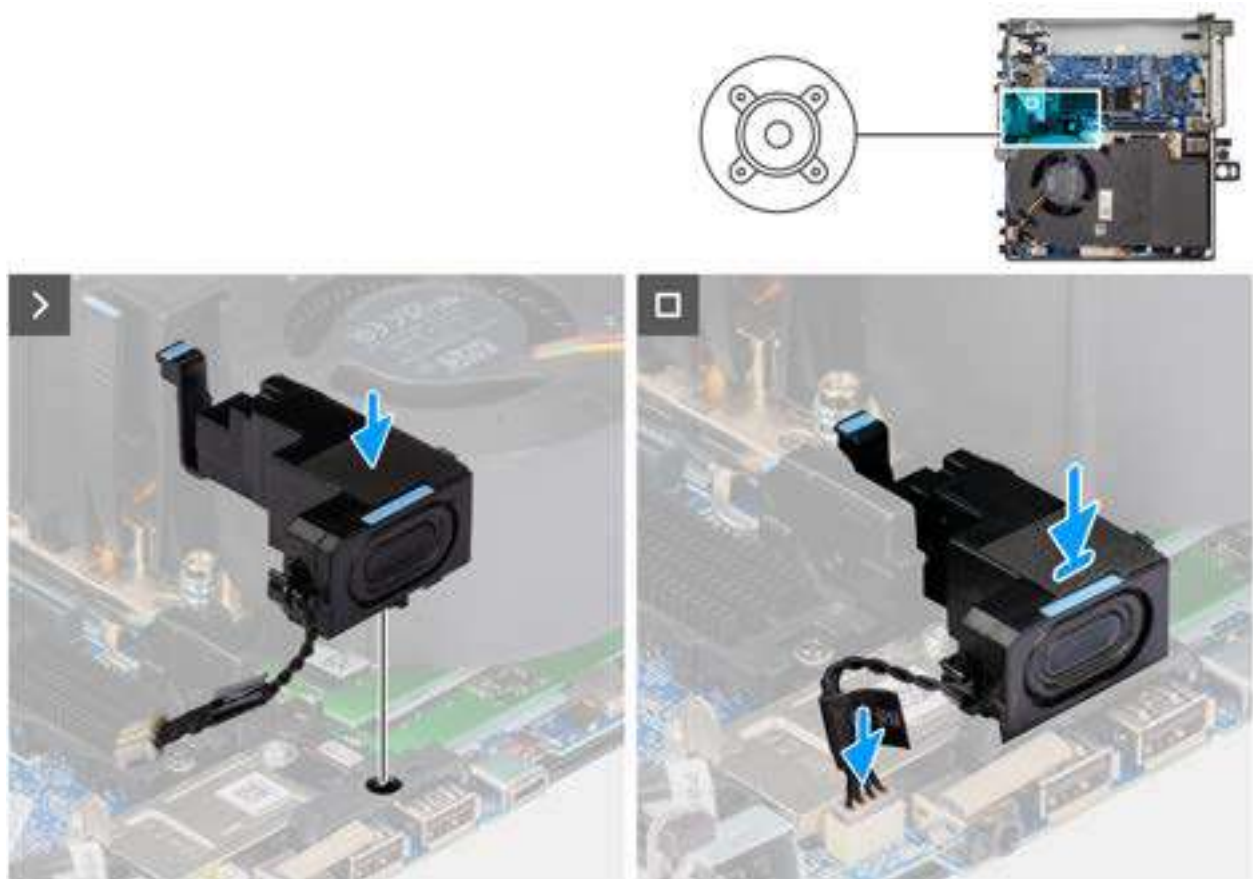
Figure 29. Installation du haut-parleur
