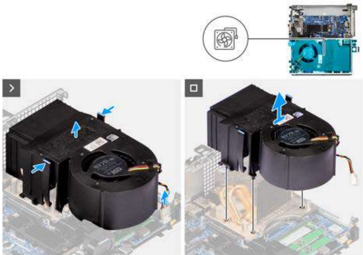
Figure 16. Retrait du ventilateur système
