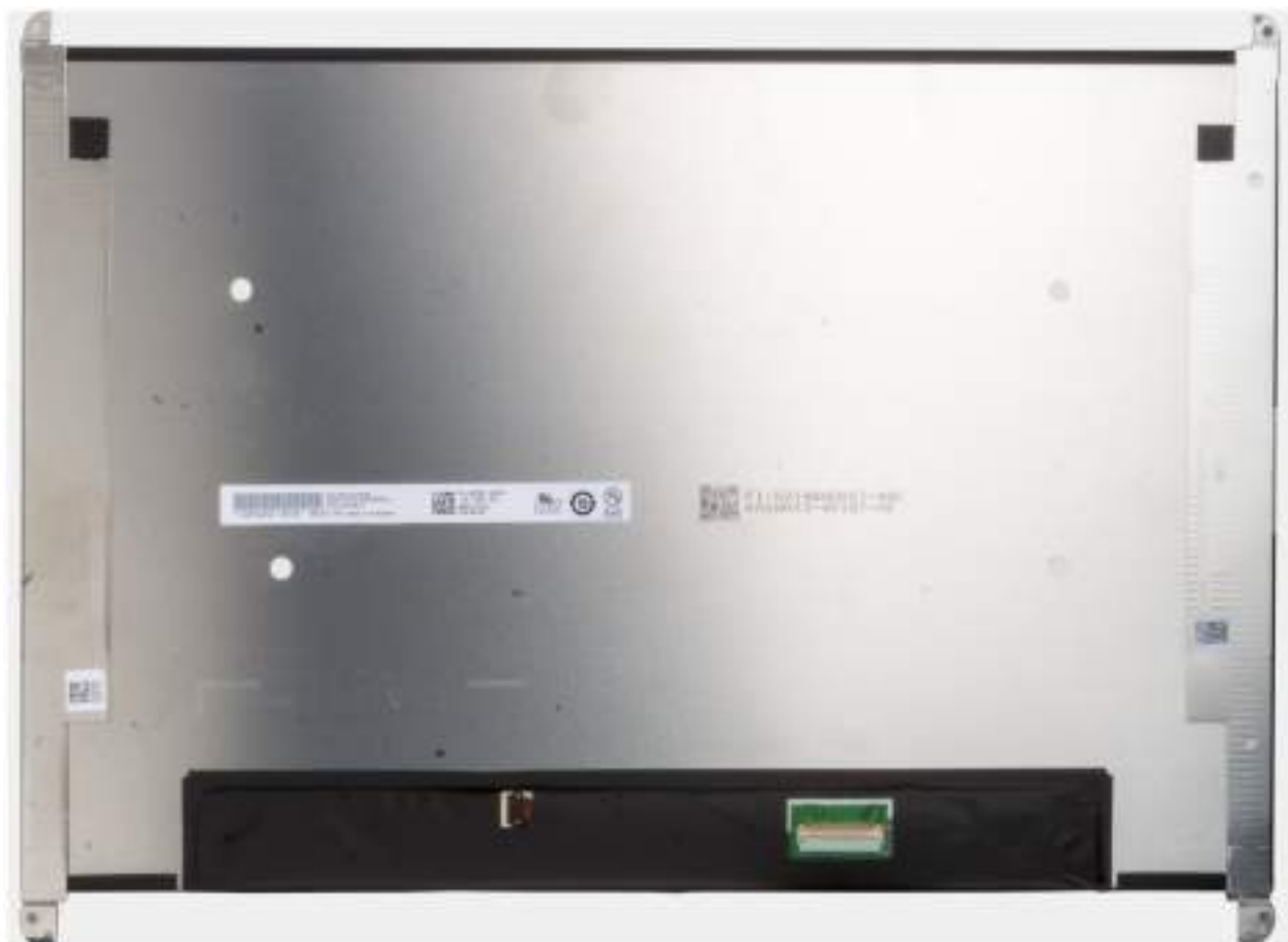
Figure 77. Panneau d'écran avec supports
