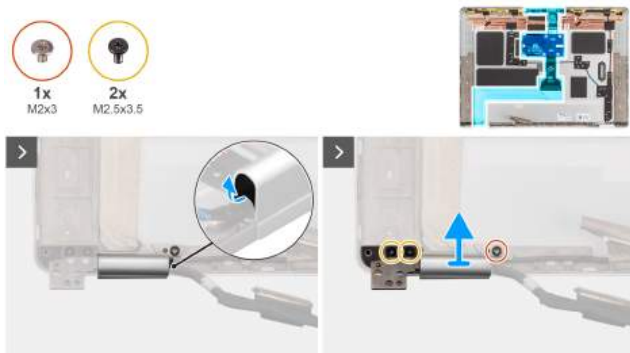
Figure 84. Retrait du câble de l'écran
