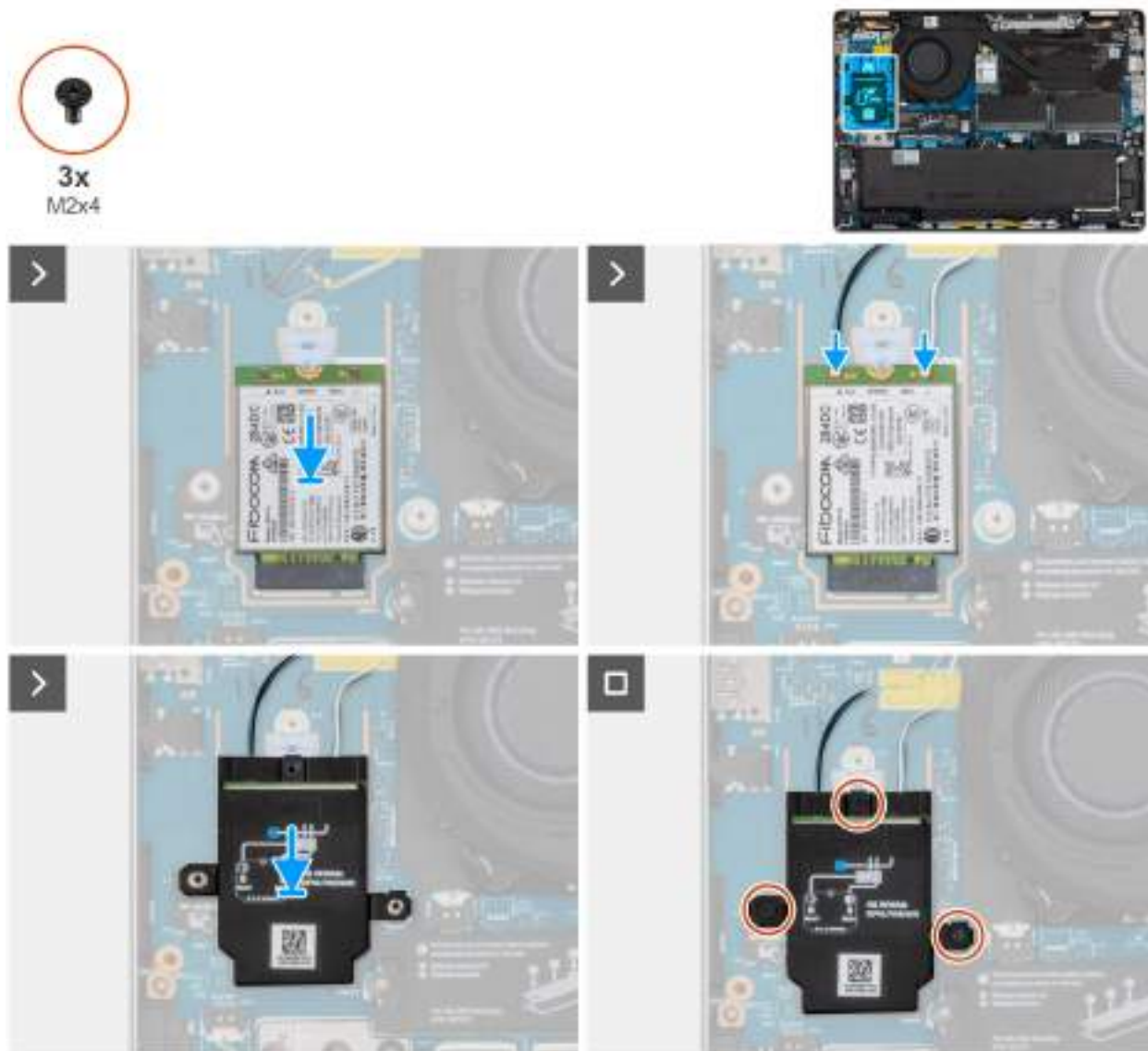
Figure 35. Installation de la carte WWAN
