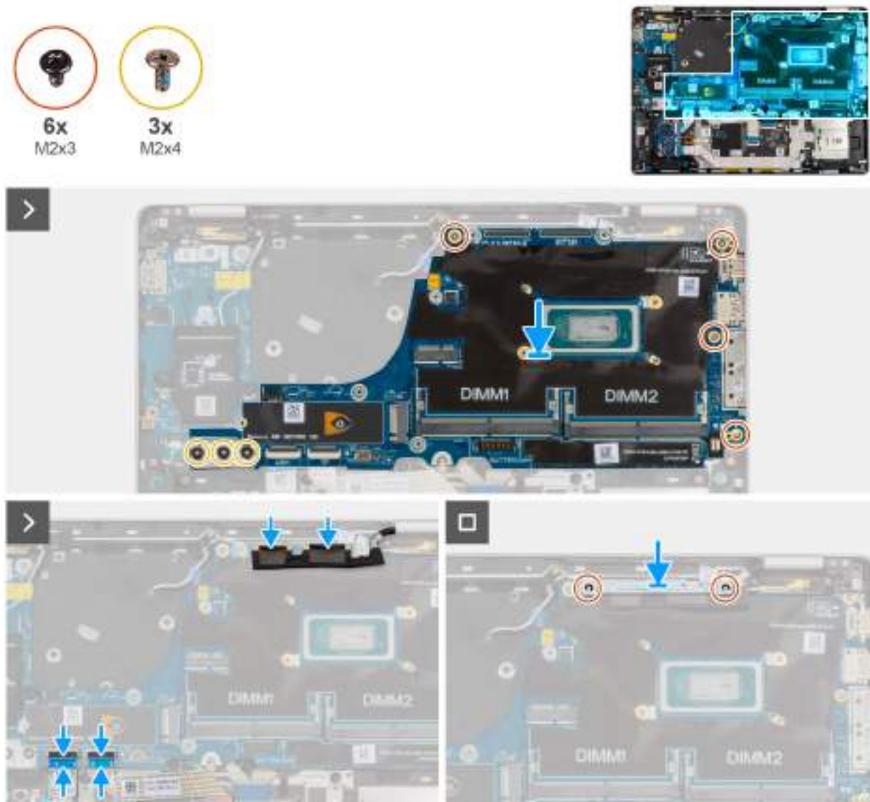
Figure 53. Installation de la carte système
