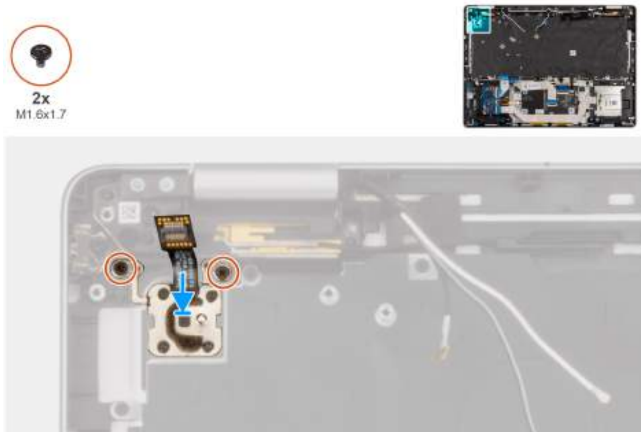
Figure 63. Installation du bouton d'alimentation avec lecteur d'empreintes digitales (en option)
