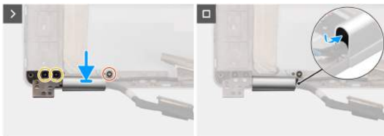
Figure 87. Installation du câble d'écran
