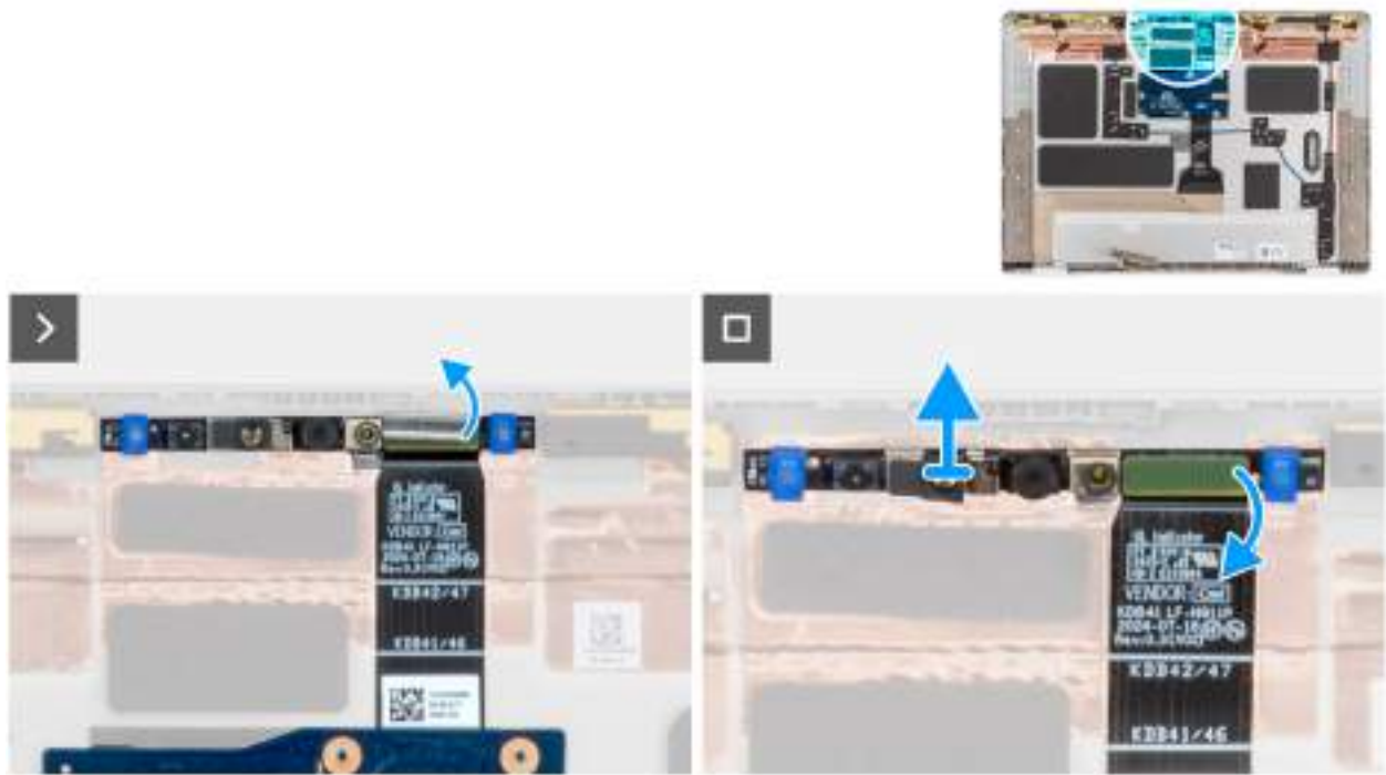
Figure 88. Retrait de la caméra MIPI
