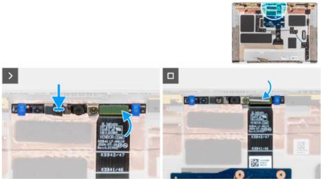
Figure 89. Installation de la caméra MIPI
