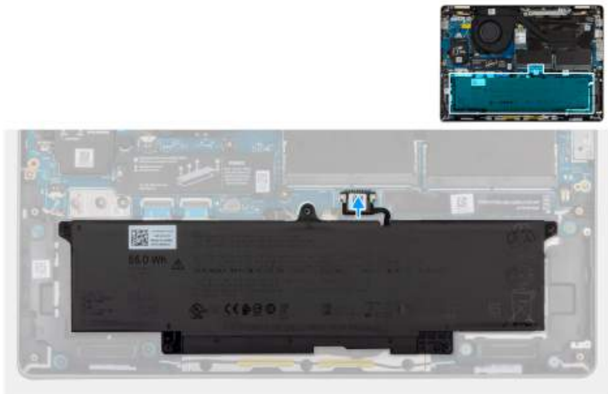
Figure 25. Connexion du câble de la batterie
