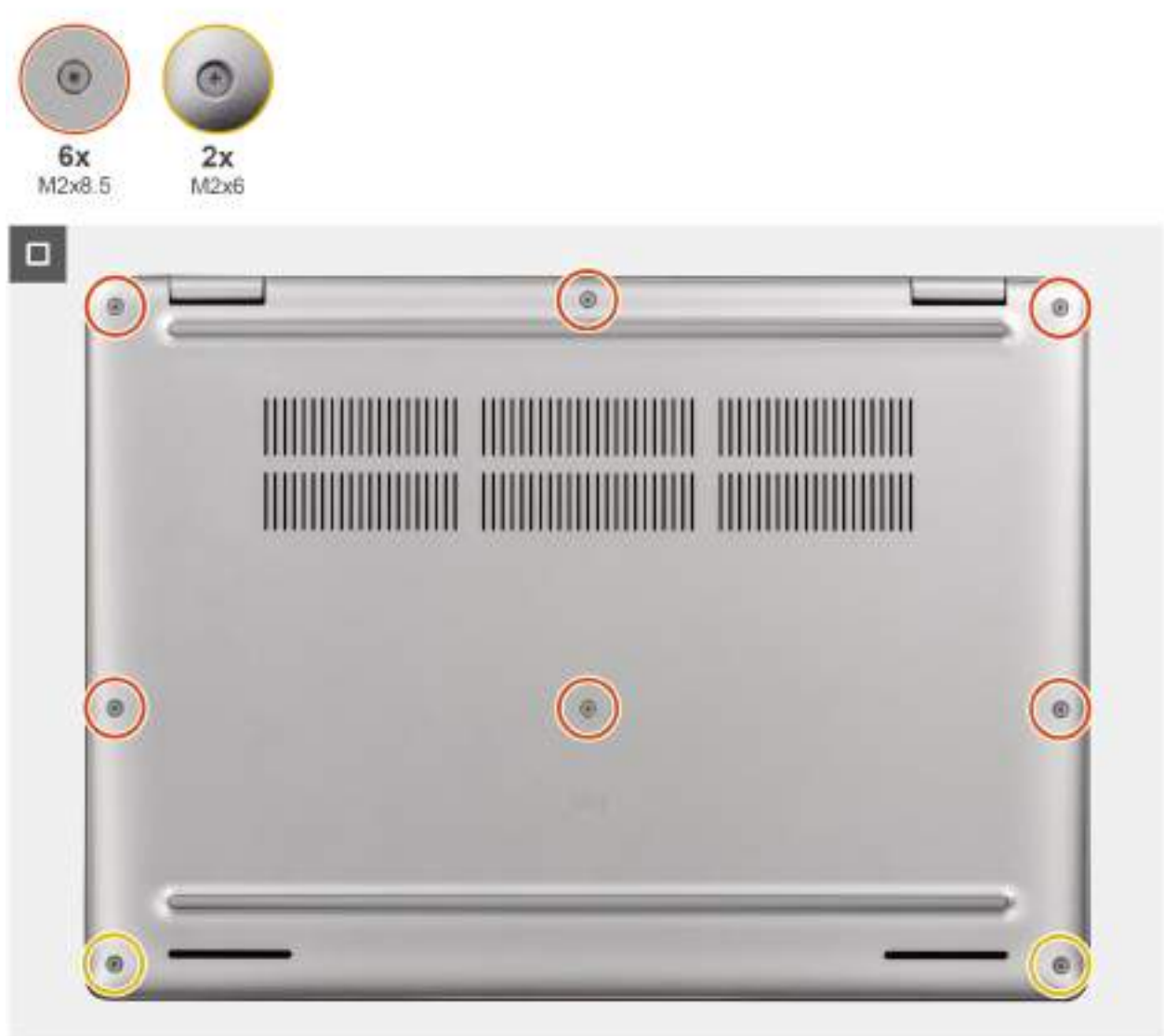
Figure 27. Installation du cache de fond
