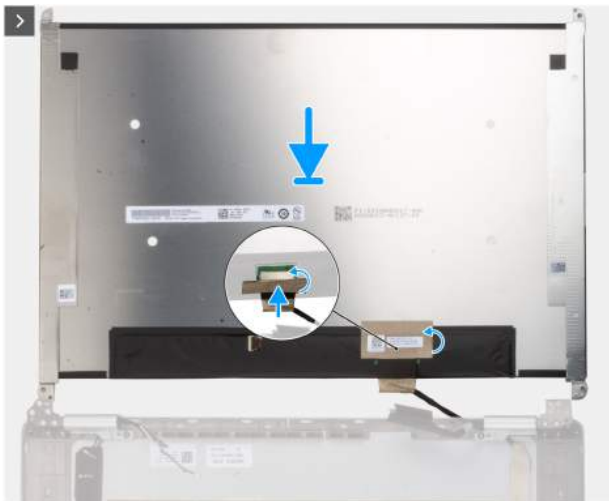
Figure 78. Installation du panneau d'écran
