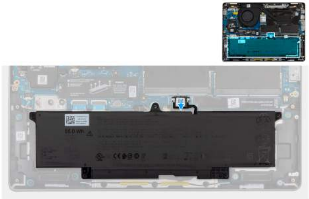
Figure 24. Déconnexion du câble de la batterie
