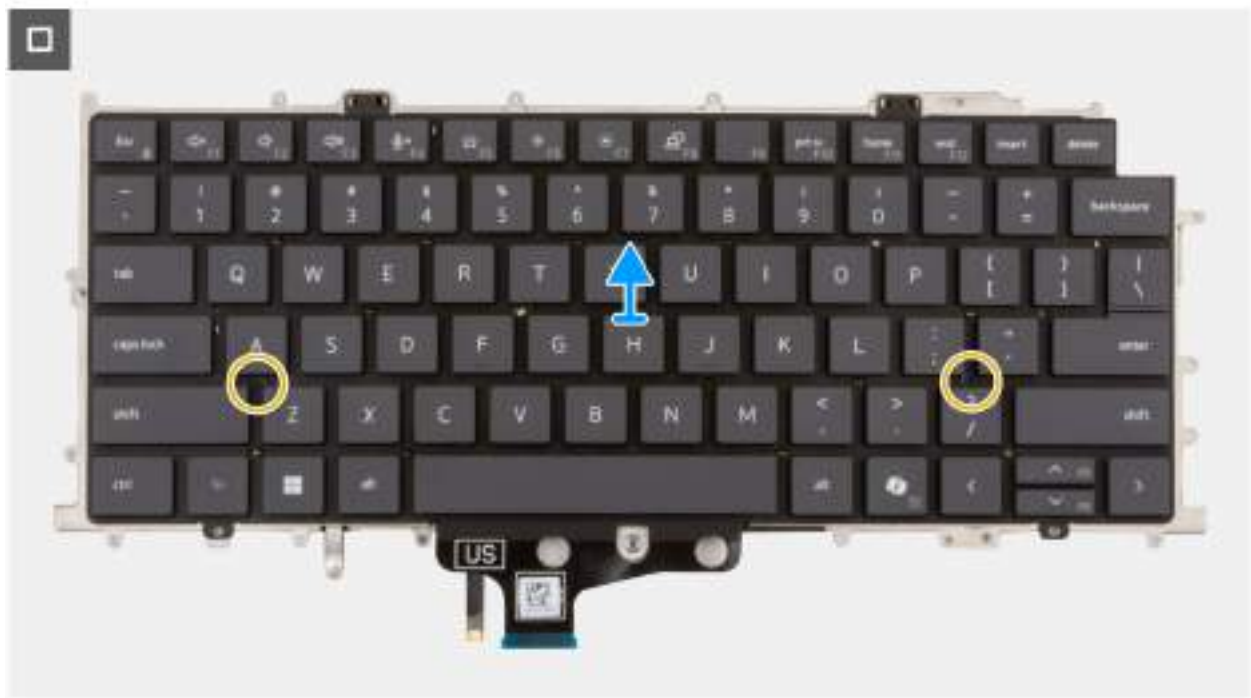
Figure 99. Retrait du clavier
