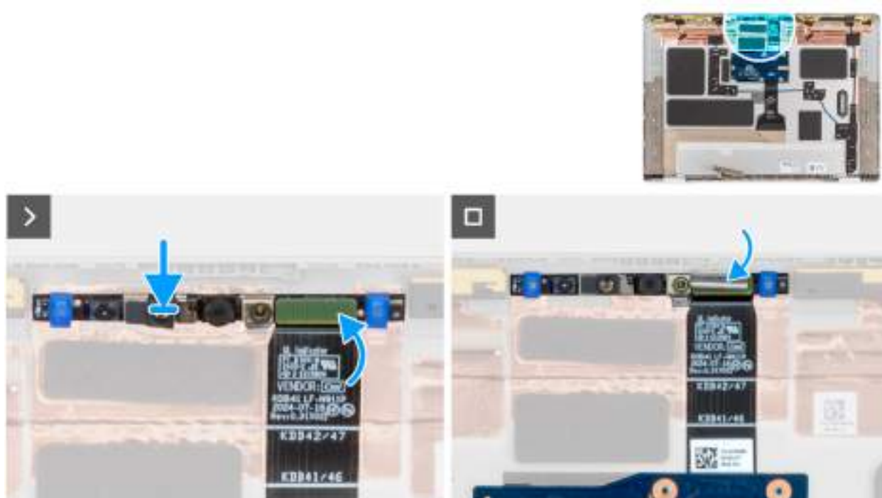
Figure 84. Installation de la caméra MIPI
