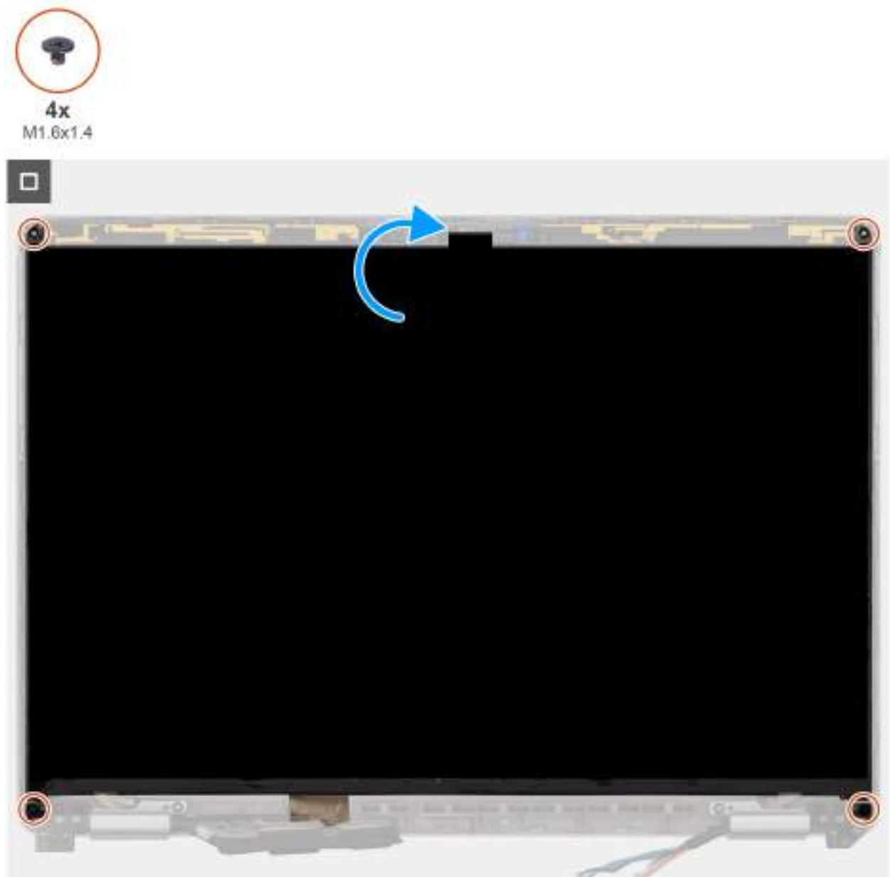
Figure 76. Installation du panneau d'écran
