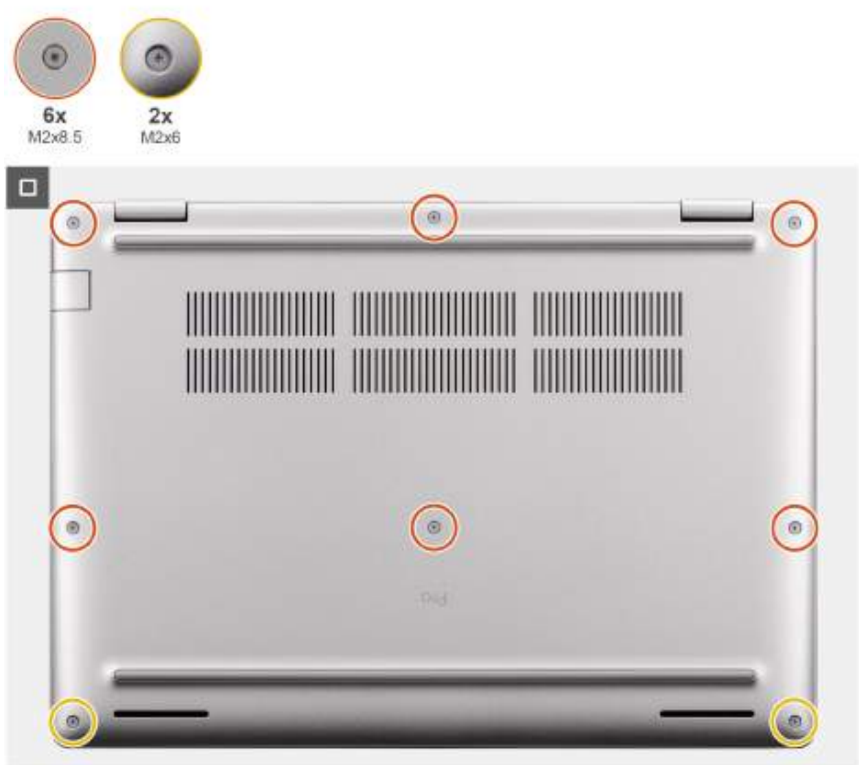
Figure 22. Installation du cache de fond
