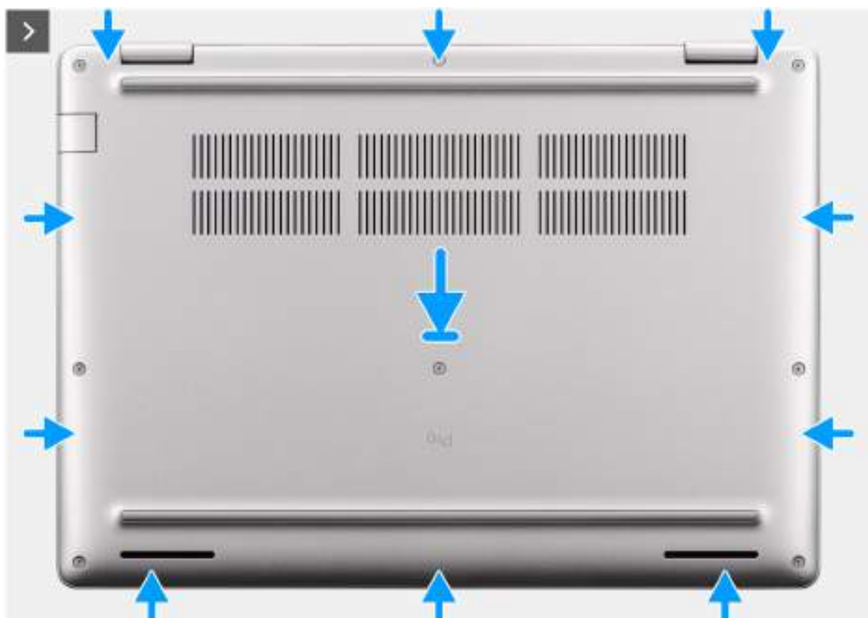
Figure 21. Installation du cache de fond
