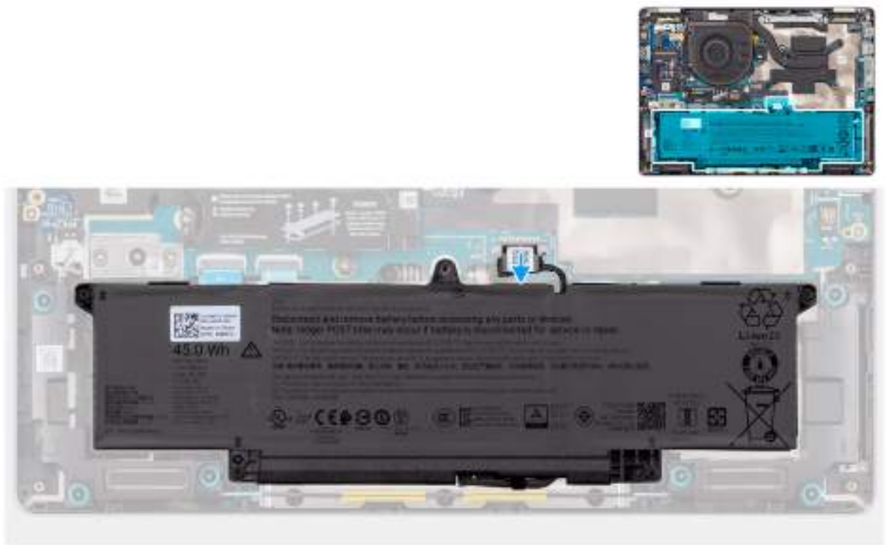
Figure 19. Déconnexion du câble de la batterie
