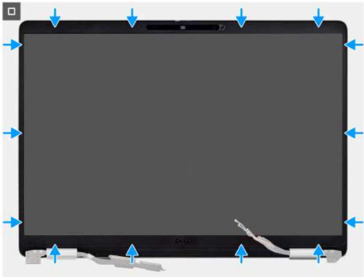
Figure 71. Installation de la bordure d'écran
