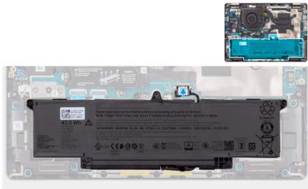
Figure 20. Connexion du câble de la batterie
