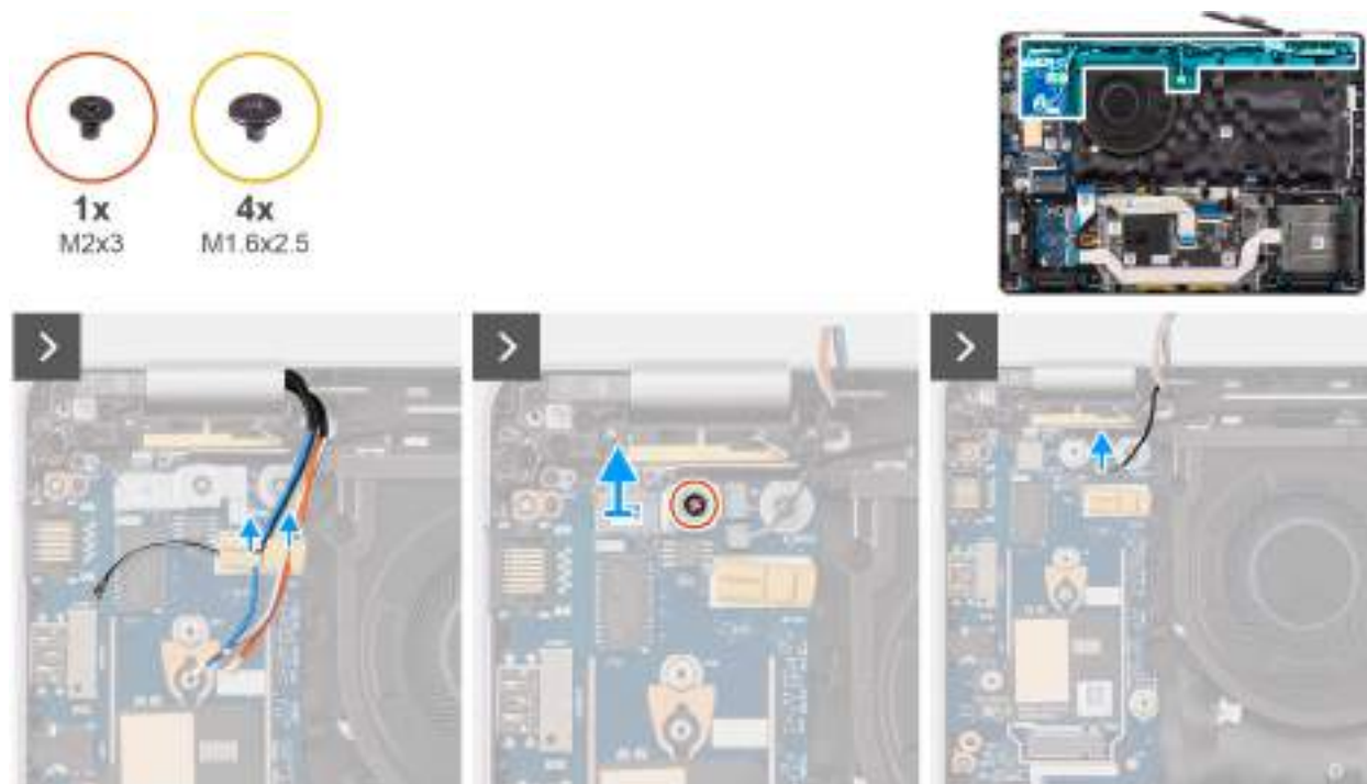
Figure 51. Retrait des modules d'antenne WLAN
