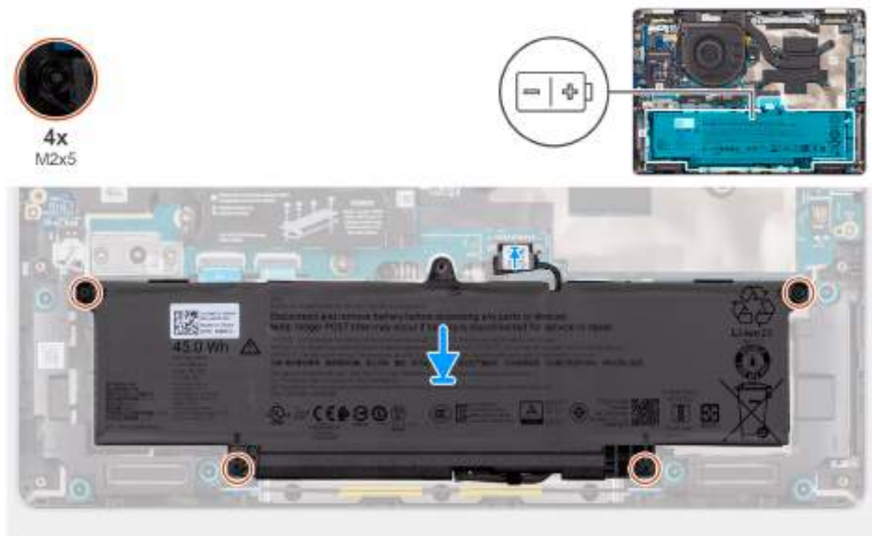
Figure 24. Installation de la batterie
