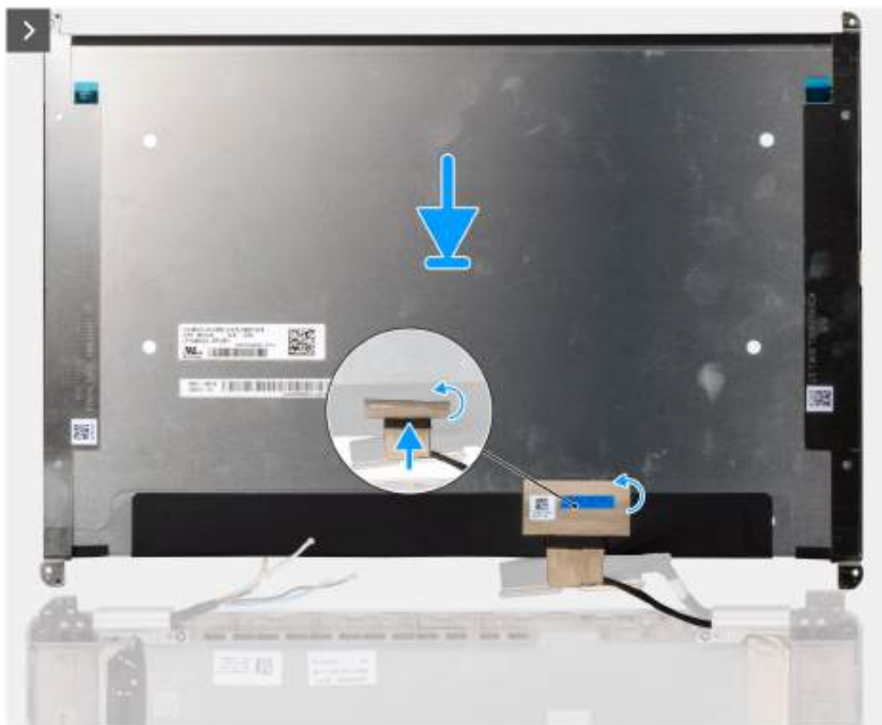
Figure 75. Installation du panneau d'écran
